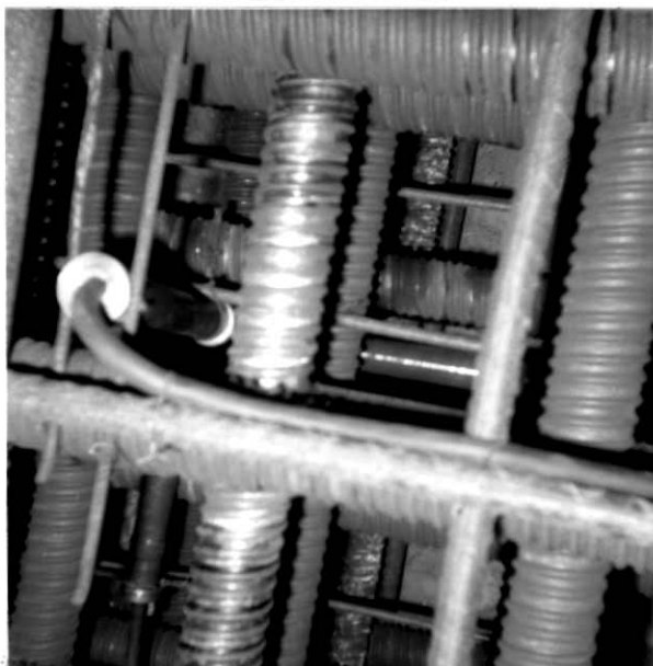
Foto 1 - Roseta de 3 extensômetros Carlson (base de medida = 25cm)
