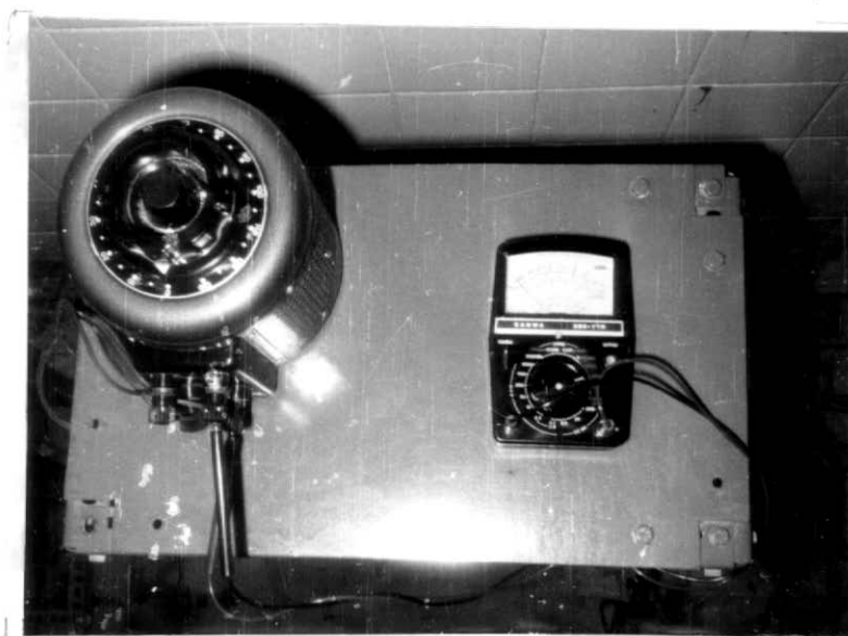
Figura 44. - Transformador e voltímetro auxiliares da bomba B.
