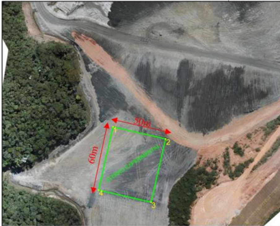
Figura 3-3 - Geometria do aterro experimental (Mineradora, 2023).
