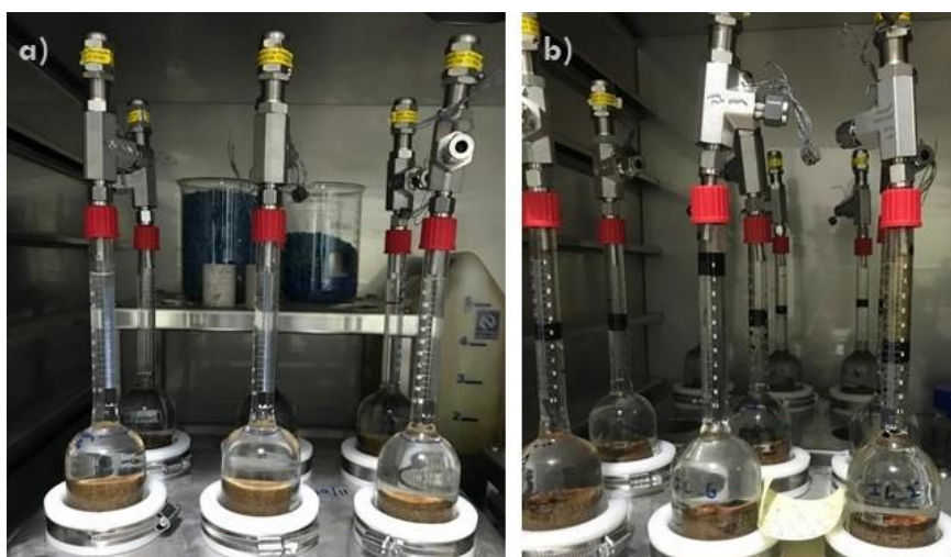
Figura 23 – Célula de Amott para embebição: a) primeiro dia de teste, b) dias depois.
