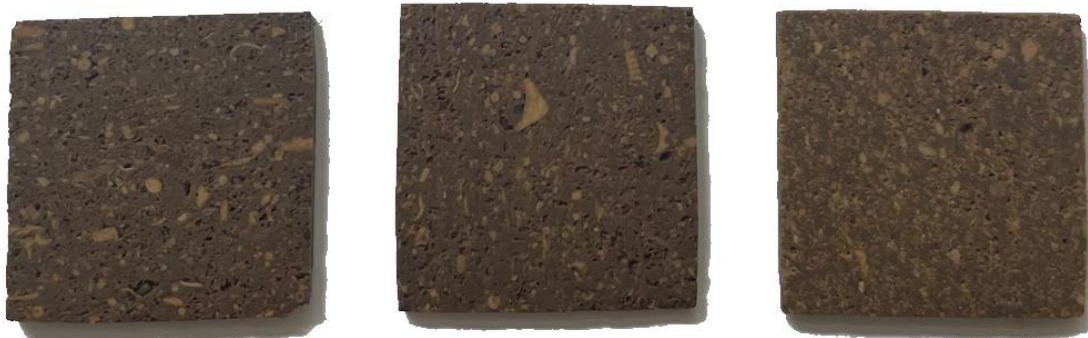
Figura 28: Slabs utilizados para experimento de ângulo de contato (imagem após o experimento).
