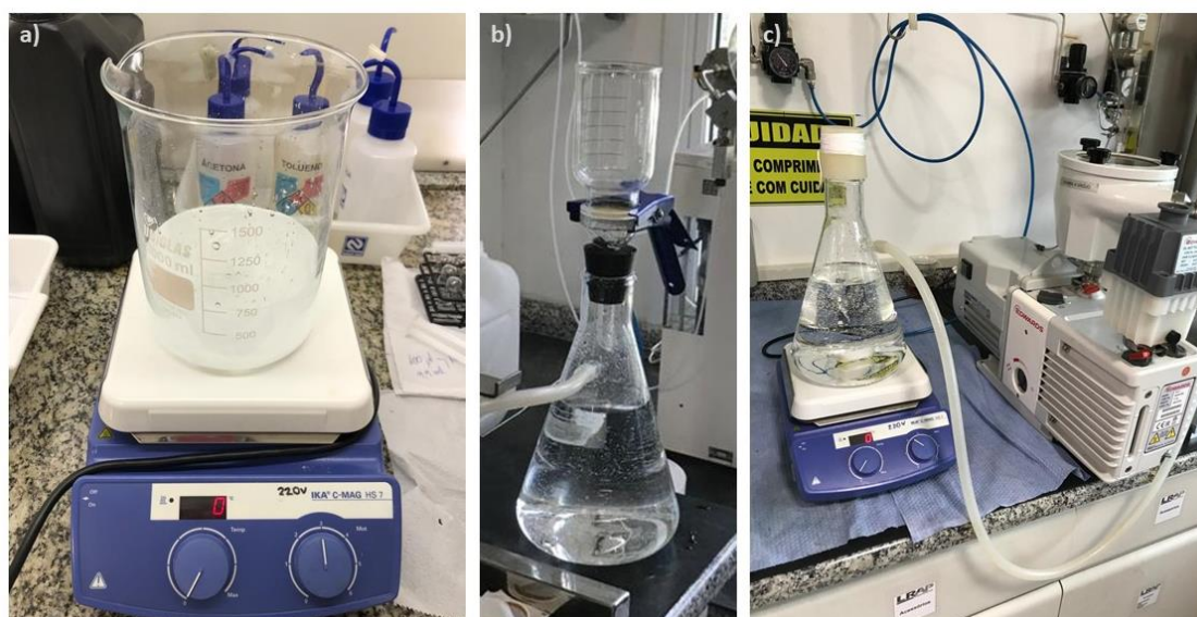
Figura 18 – Preparo das salmouras. a) misturador, b) filtração, c) desaerador.
