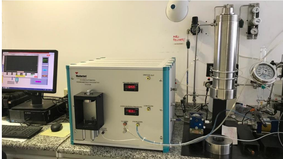
Figura 19 – Poro-permeâmetro para medidas de petrofísica de rotina.
