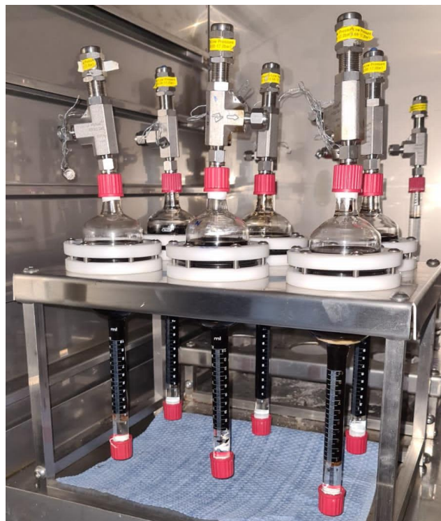
Figura 25 – Célula de Amott para drenagem espontânea.
