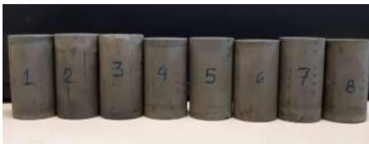
Figura 37: Corpos de prova faceados para ensaio de resistência compressiva
