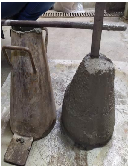
Figura 3.12: Procedimento realizado para obtenção do abatimento do tronco de cone
