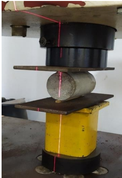
Figura 3.14: Resistência à tração por compressão diametral
