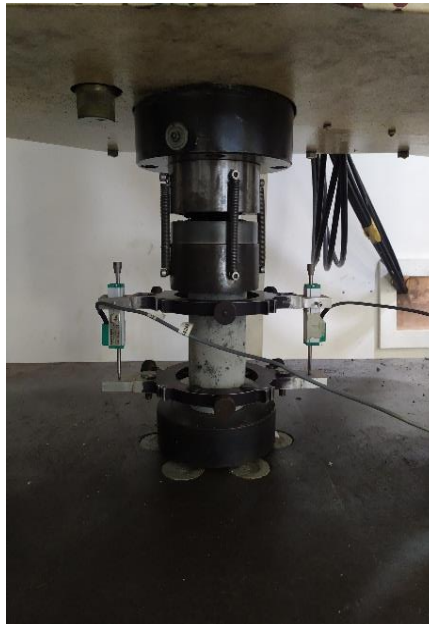
Figura 3.13: Resistência à compressão axial
