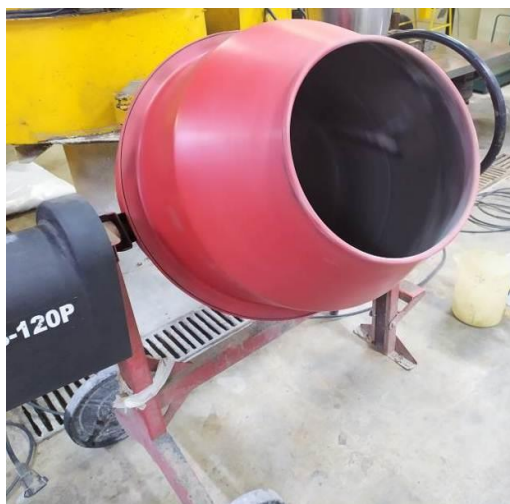
Figura 3.9: Betoneira do fabricante GMEG – MOTOMIL com capacidade de 120l
