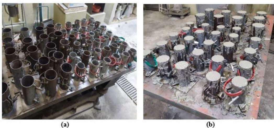
Figura 3.11: (a) preparação dos moldes diretamente na mesa vibratória; (b) preenchimento das camadas de concreto
