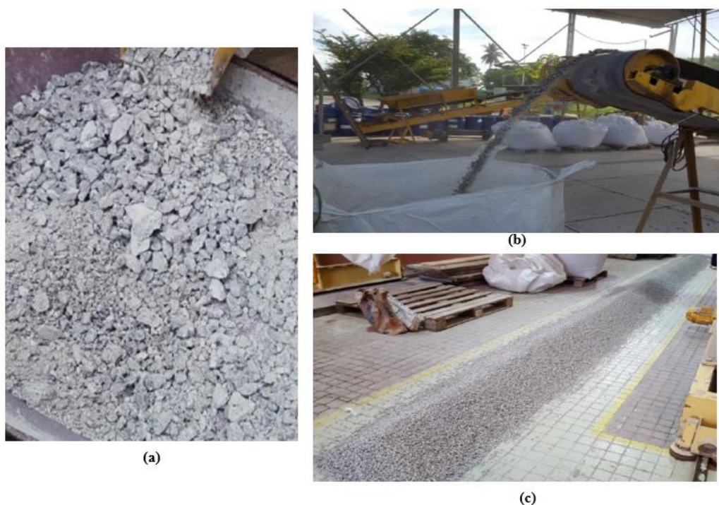
Figura 3.1: (a) fração grossa após a britagem; (b) Processo de peneiramento; (c) Pilha de homogeneização
