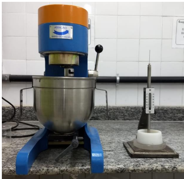
Figura 3.8: Misturador mecânico utilizado e aparelho de Vicat
