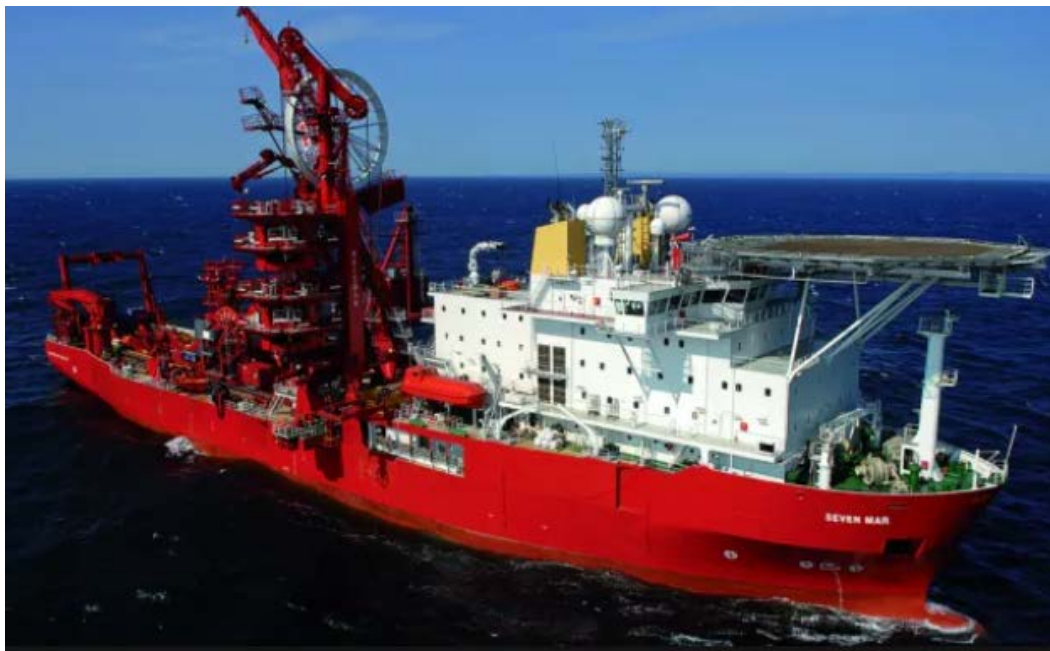
Figura 3.3-3 – Instalação pelo Costado com Torre - Fonte: Subsea 7
