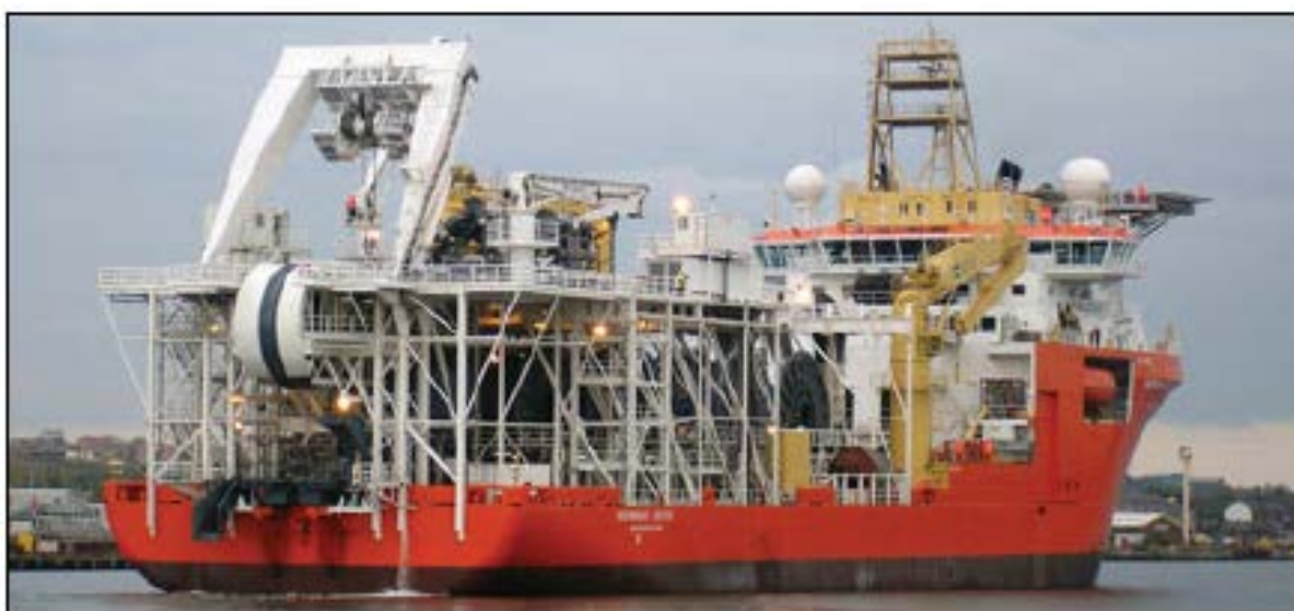
Figura 3.3-2 – Instalação pela Popa com Calha Rotativa- Fonte: Subsea 7
