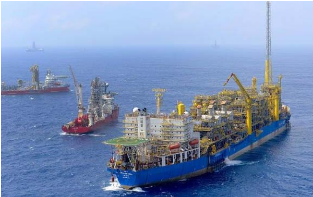
Figura 4.3-2 – Navios operando em DP próximos a Plataforma – [29]
