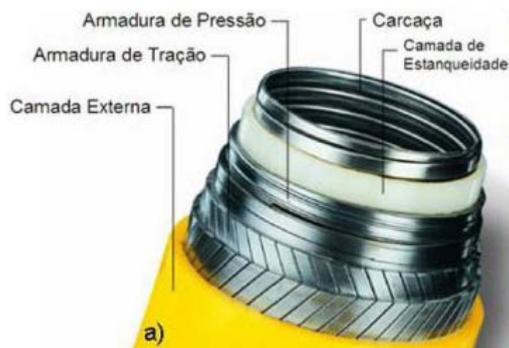
Figura 2.2-4 – Seção Típica de um Duto Flexível - [10]
