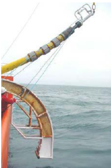
Figura 3.3-1 – Calha para Overboard - Fonte: Subsea 7
