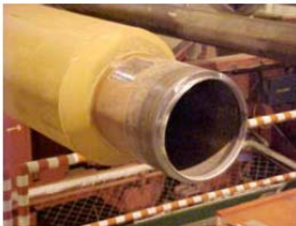
Figura 2.2-1 – Duto Rígido com Revestimento - [6]
