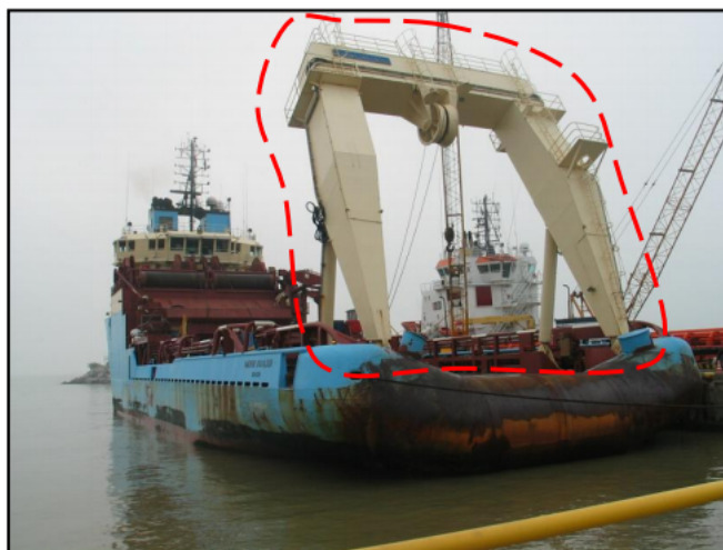
Figura 3.2 - Embarcação de instalação de equipamentos pelo método vertical via cabo com a utilização de A-frame. [26]
