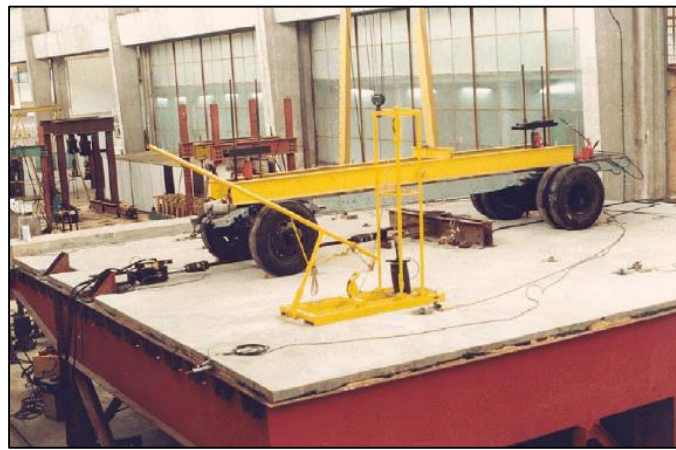
Figura 1-10. Modelo físico do tabuleiro sanduíche testado experimentalmente.
