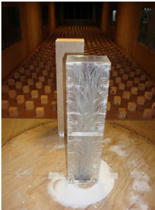
Figura 6.7 – Modelo de tomada de pressões do edifício CAARC, utilizado por OLIVEIRA (2009)
