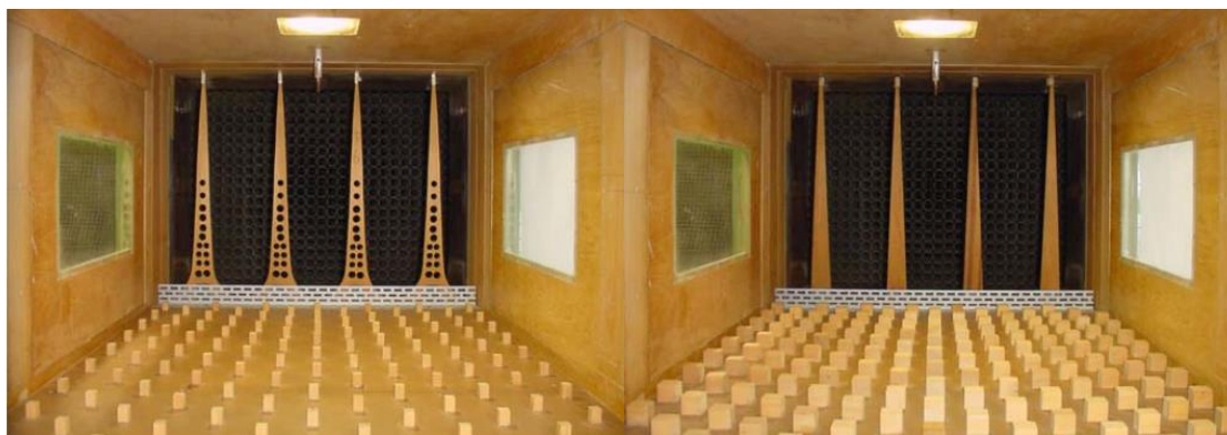
Figura 6.8 - Dispositivos de geração das diferentes camadas limites do túnel de vento Prof. Joaquim Blessmann. a) p = 0,23 ; b) p = 0,34 . (LOREDO-SOUZA et al., 2004).
