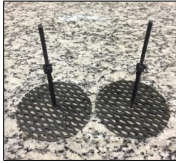
Figura 3.12. Eletrodos de DSA® fabricados sob medida pela DE NORA do Brasil Ltda..
