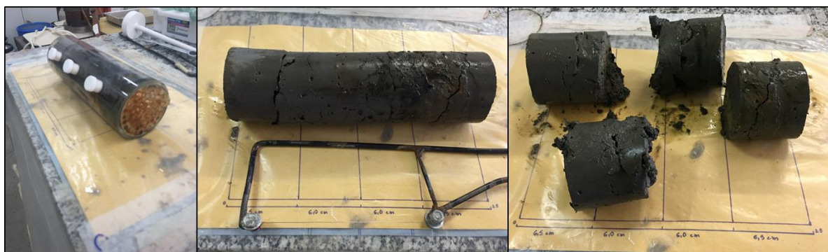
Figura 4.20. Amostra de solo contida na célula eletrocinética sendo retirada e dividida em 4 fatias para análises pós ensaios.
