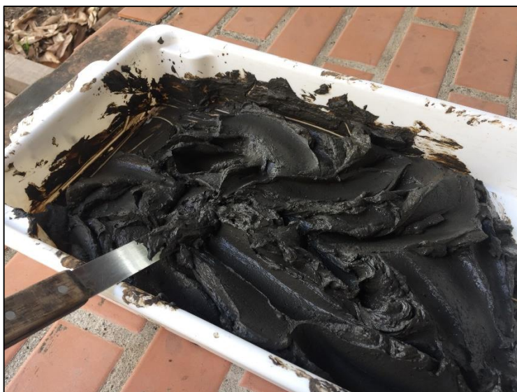
Figura 3.6. Homogeneização do solo com o óleo diesel no processo de contaminação das amostras.
