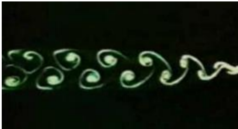
Figura 2-1 – Visualização do desprendimento de vórtice, provocado pela passagem de um fluxo ao redor de um obstáculo (FRANÇA, 2015)
