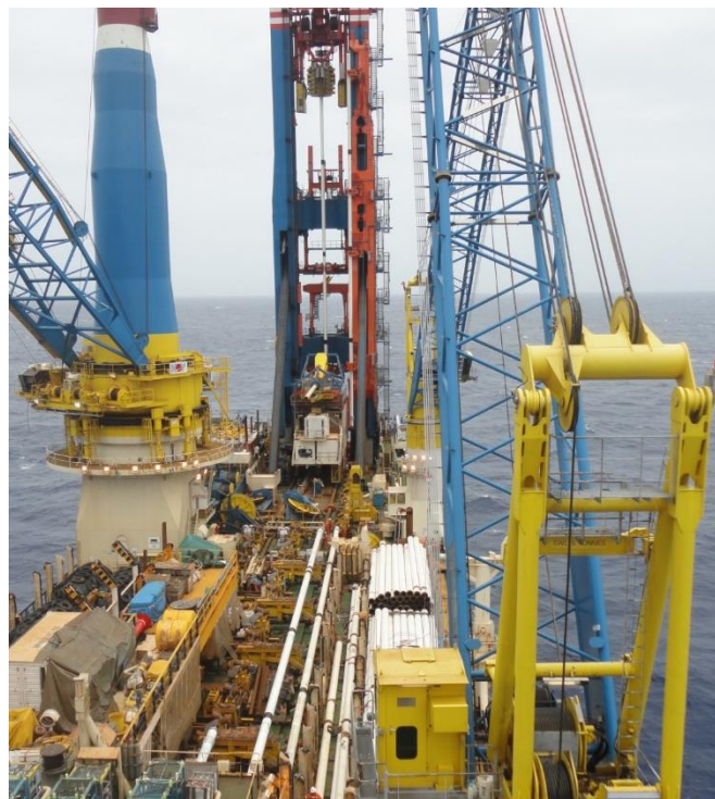
Figura 1-1 - Fabricação offshore de um duto rígido submarino
