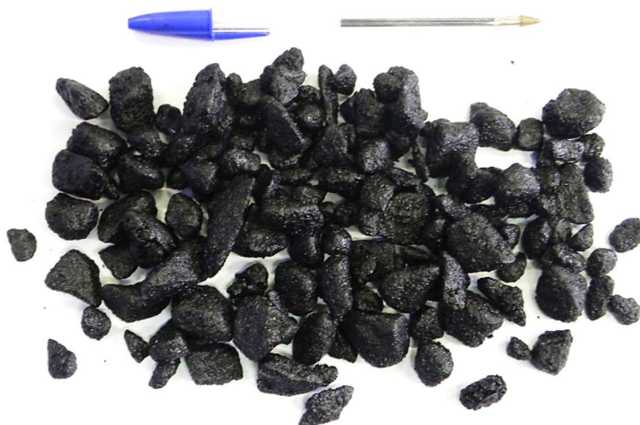
Figura 10: Recobrimento dos agregados gráudos da WMA2 desta pesquisa
