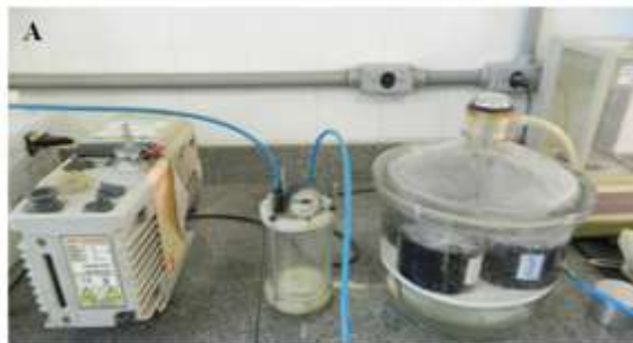
A – Aplicação de vácuo nos CPs
