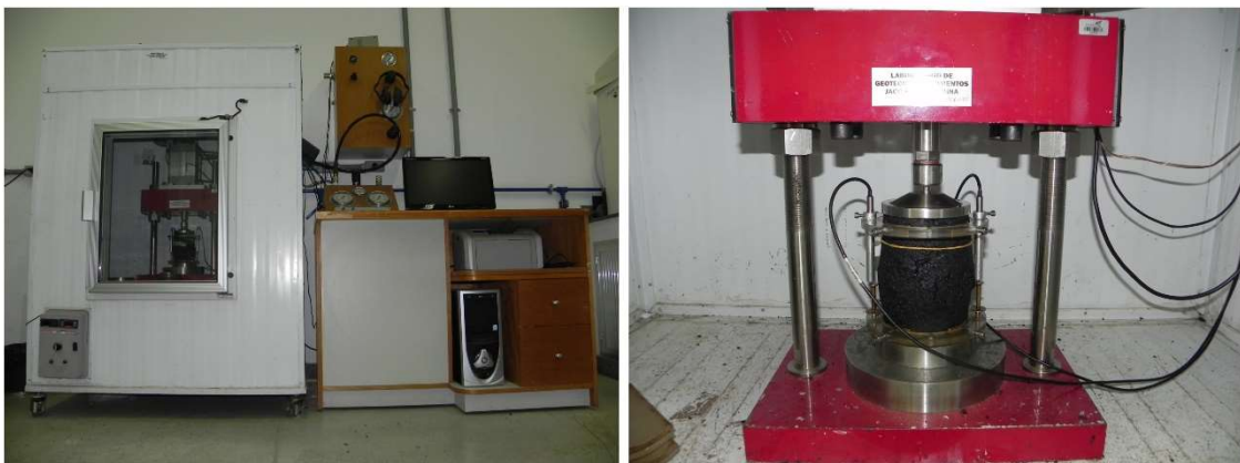
Figura 18: Equipamento do Laboratório de Pavimentação da COPPE utilizado no ensaio uniaxial de carga repetida para determinação da resistência à deformação permanente (FN)
