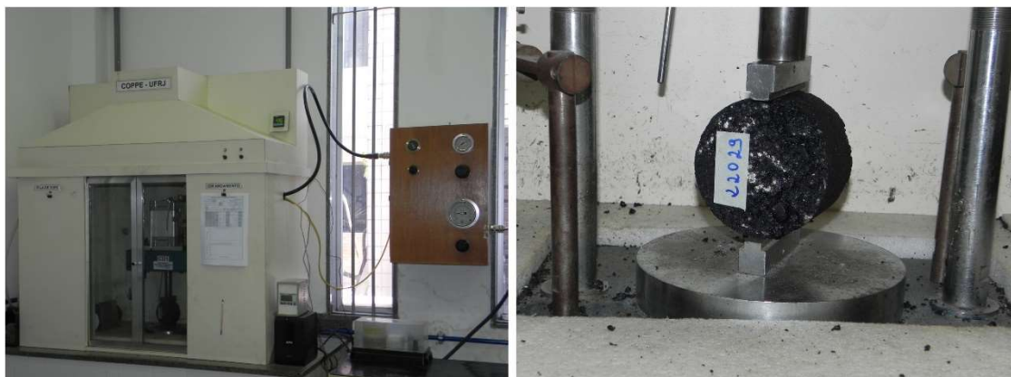
Figura 19: Equipamento do Laboratório de Pavimentação da COPPE utilizado no ensaio de fadiga
