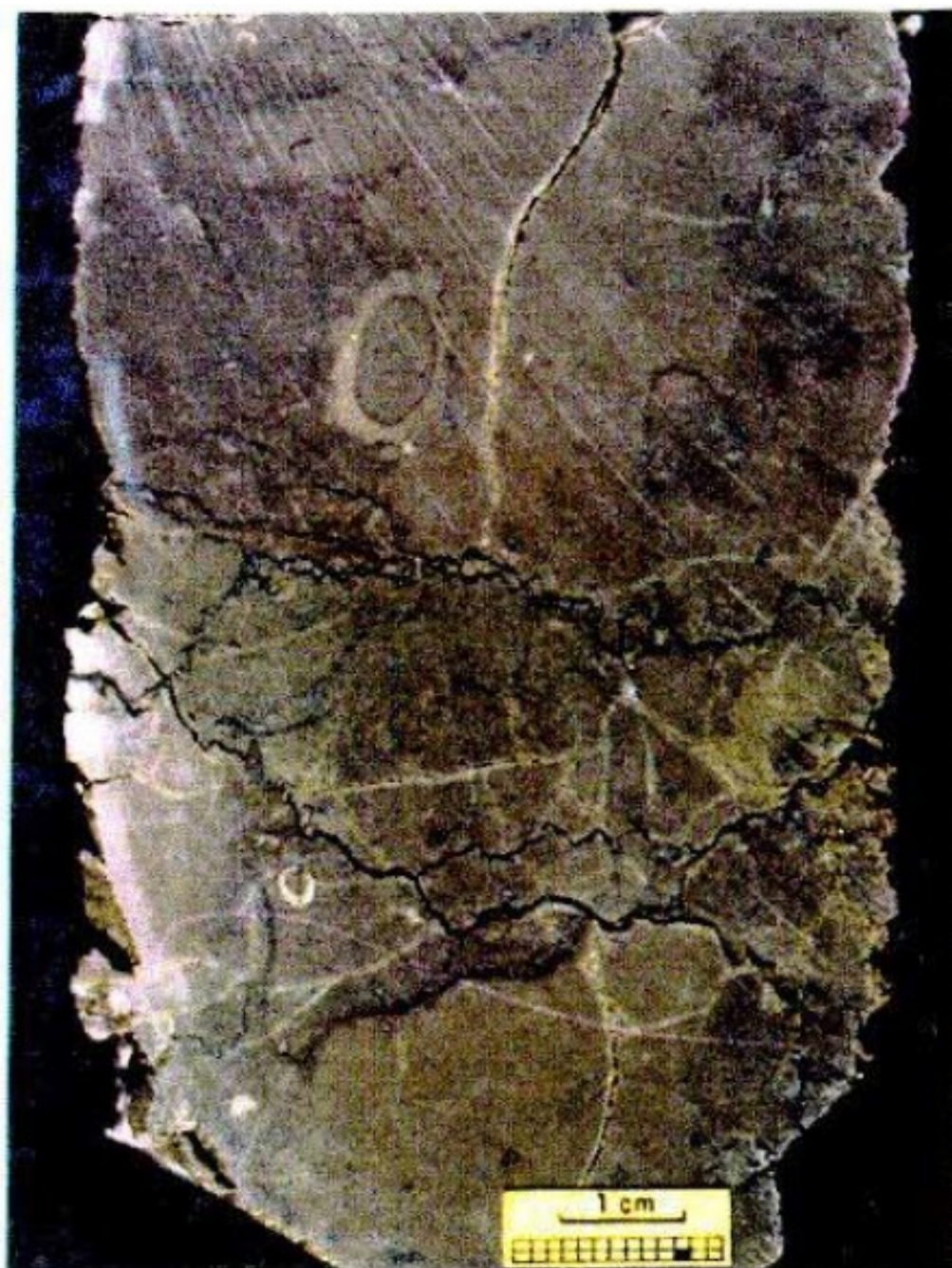
Figura A.1: Calcário compacto fechado - testemunho 1 do poço 1-BSS-0055-BS.
