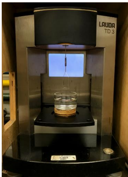
Figura 18 – Determinação da tensão superficial usando o método do anel
