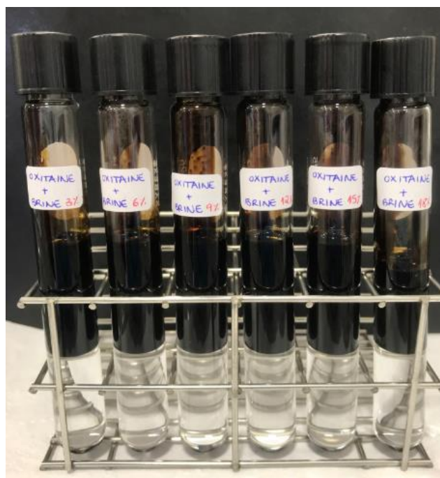
Figura 20 – Montagem do teste de triagem de salinidade
