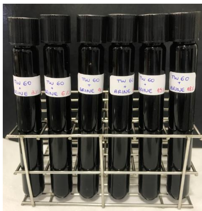
Figura 21 – Tubos de ensaio para a triagem de salinidade após agitação
