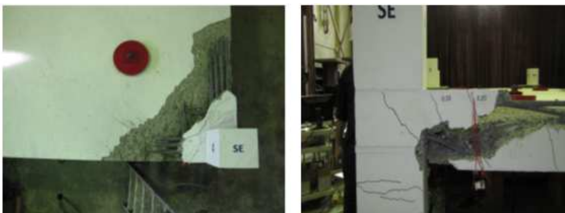
Figura 6.7 – Aspecto pós-ruptura por punção de região de pilar de canto (ZHANG, 2014)
