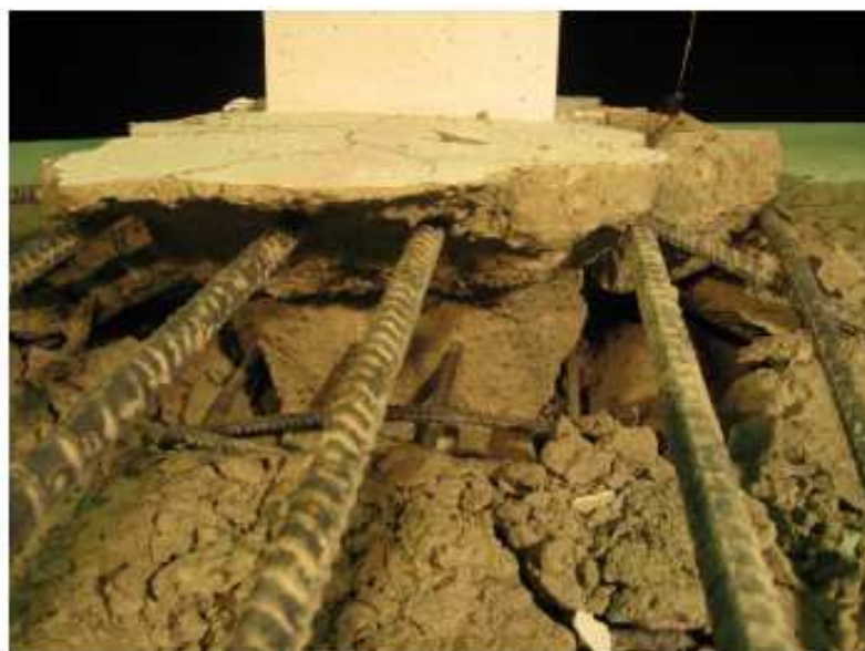
Figura 6.6 – Aspecto pós-ruptura por punção de região de pilar interno, mostrando a armadura de integridade e o “tronco de pirâmide de punção” (HABIBI, 2012)
