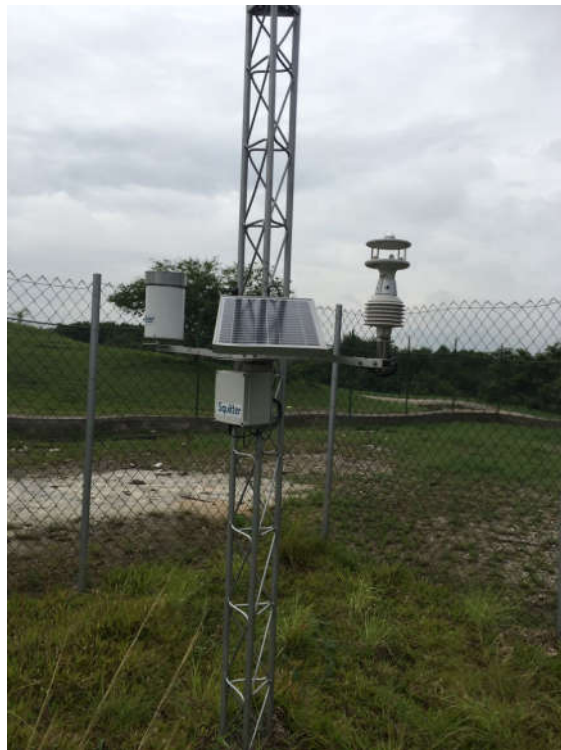
Figura 3.5: Estação meteorológica do Instituto de Geociências – UFRJ
