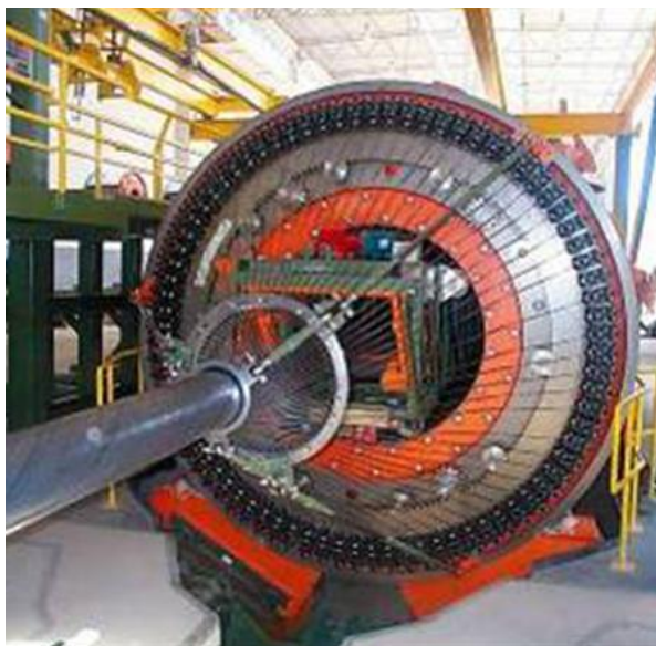
Figura 2.7 - Assentamento das armaduras de tração (BARTELI, 2017)
