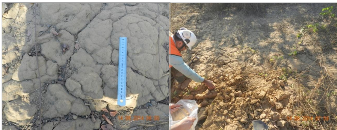
Fig. 3.2. (a) Trincamento in situ do material (b) Aspecto geral do material no momento da coleta - LA' (GUIMARÃES & SANTANA, 2014).
