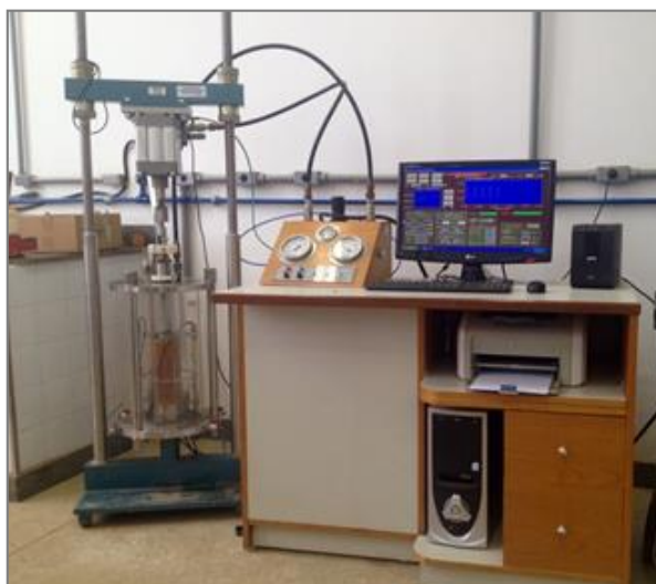
Fig. 3.18. Equipamento triaxial de carga repetida da COPPE/UFRJ usado nesta pesquisa.
