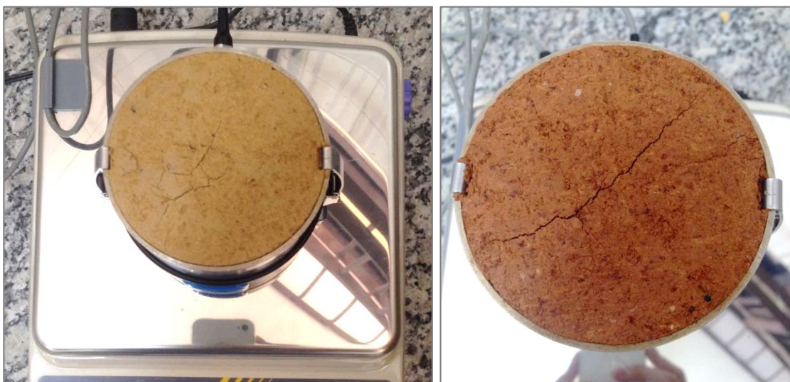
Fig. 3.17. Superfície do CP após montagem final do ensaio: (a) amostra LA' e (b) amostra LAT.
