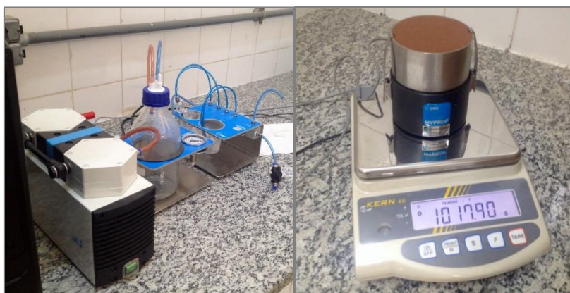
Fig. 3.15. (a) HYPROP Refill Unit. (b) Conjunto: balança de precisão, unidade sensora e corpo de prova.
