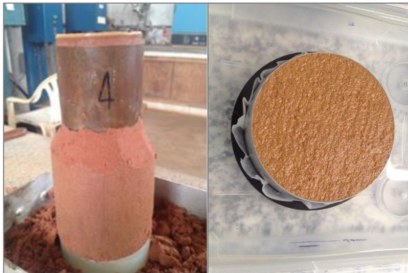
Fig. 3.10. (a) Etapa 04: Fim da cravação do amostrador no CP (10x20 cm). (b) Etapa 05: Nivelamento e escarificação do topo e da base do CP final.
