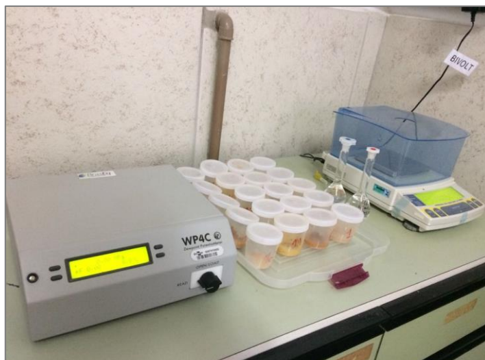
Fig. 3.16. Equipamento WP4-C e alguns acessórios posicionados para a realização do ensaio.
