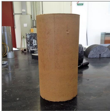
Fig. 4.24. Aspecto do corpo de prova da amostra 1 desta pesquisa pronto para ser ensaiado – LA'.
