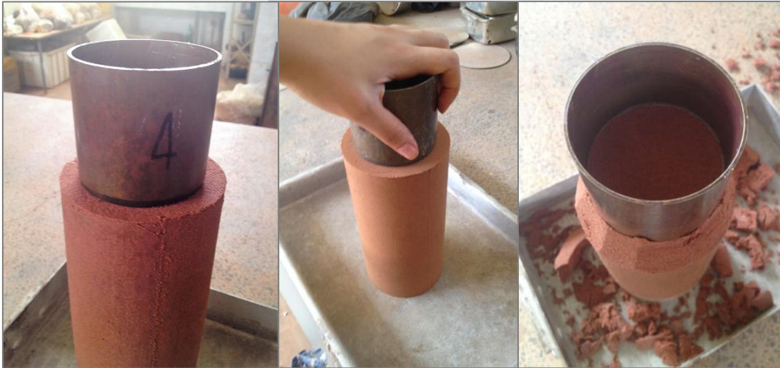
Fig. 3.11(a) Etapa 01: Posicionamento. (b) Etapa 02: Início da cravação. (c) Etapa 03: Entalhe.
