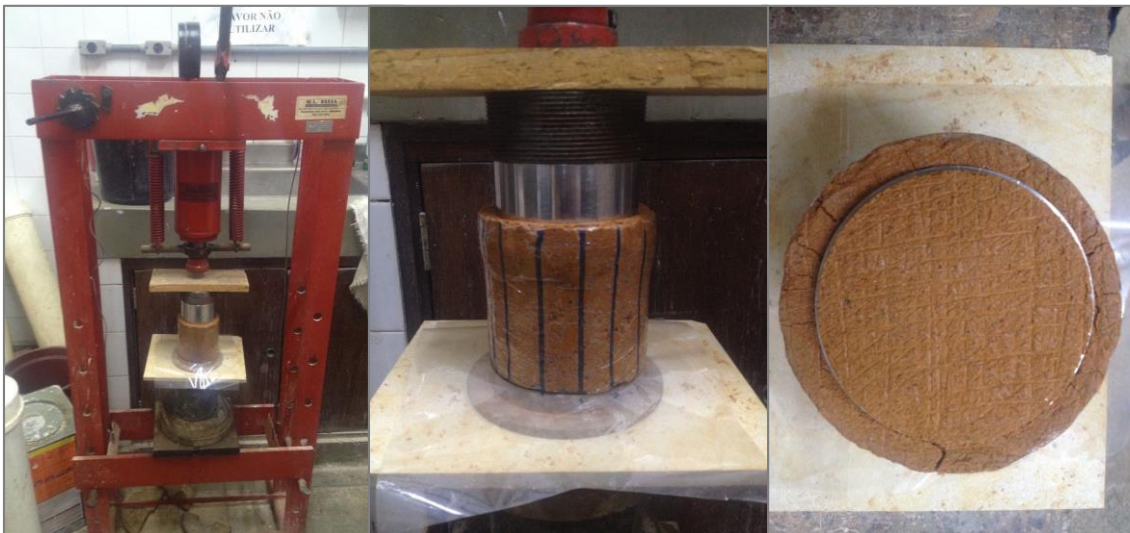
Fig. 3.13. (a) Etapa 04: Posicionamento. (b) Etapa 05: Cravação. (c) Etapa 06: Nivelamento e escarificação.
