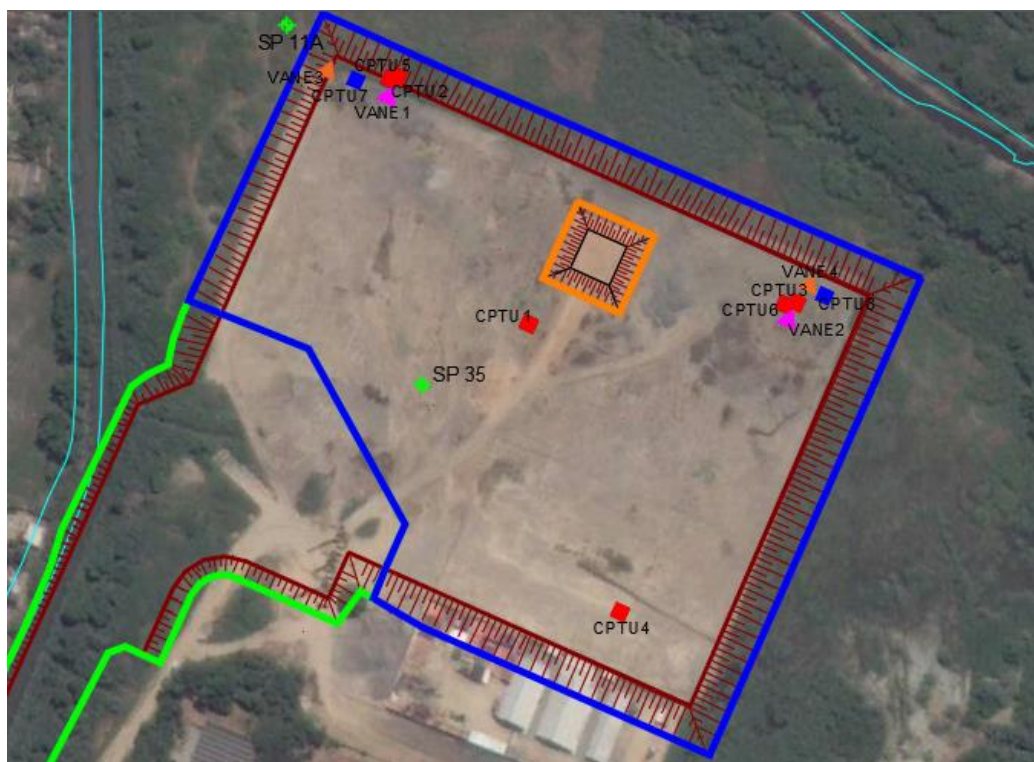
Figura 3.13 – Localização investigação geotécnica
