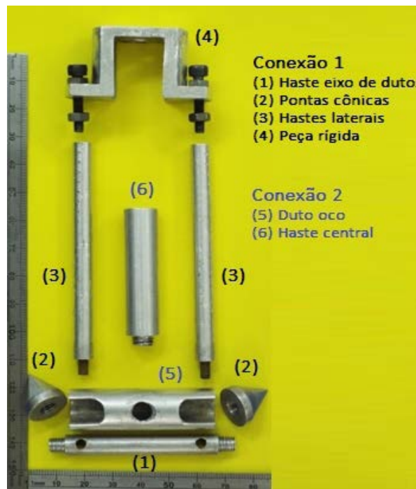
Figura 3.9. Conexões do duto axial.
