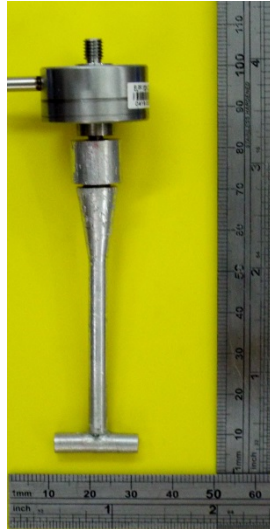
Figura 3.15. Penetrômetro T-bar com célula vertical.
