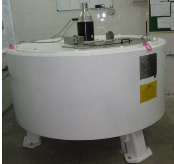
Figura 3.2. Centrífuga de braço da COPPE (ALMEIDA et al , 2014).
