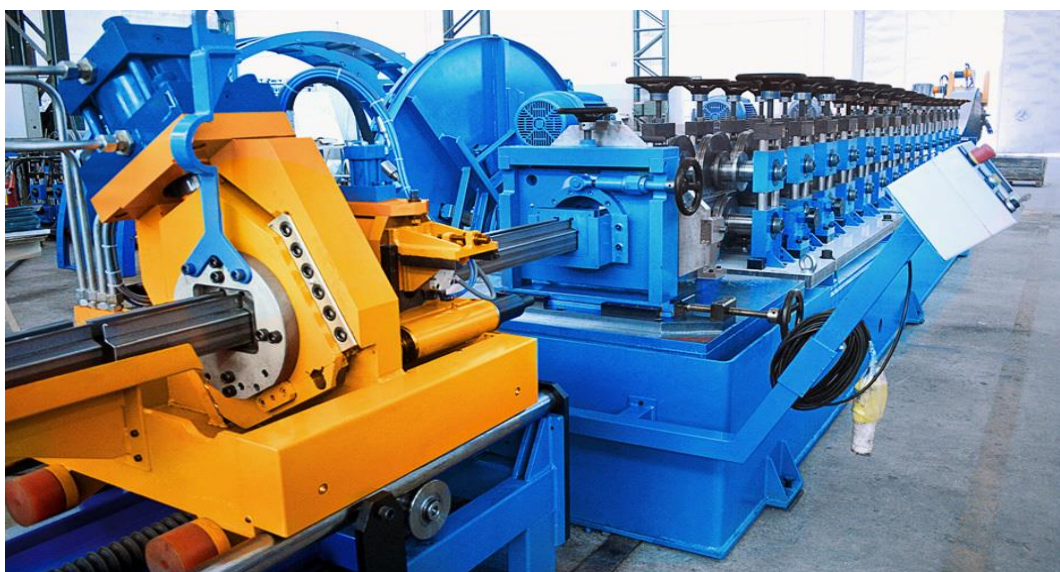
Figura 1.1 – Fabricação de perfis formados a frio empregando perfiladeira (ZIKELI)
