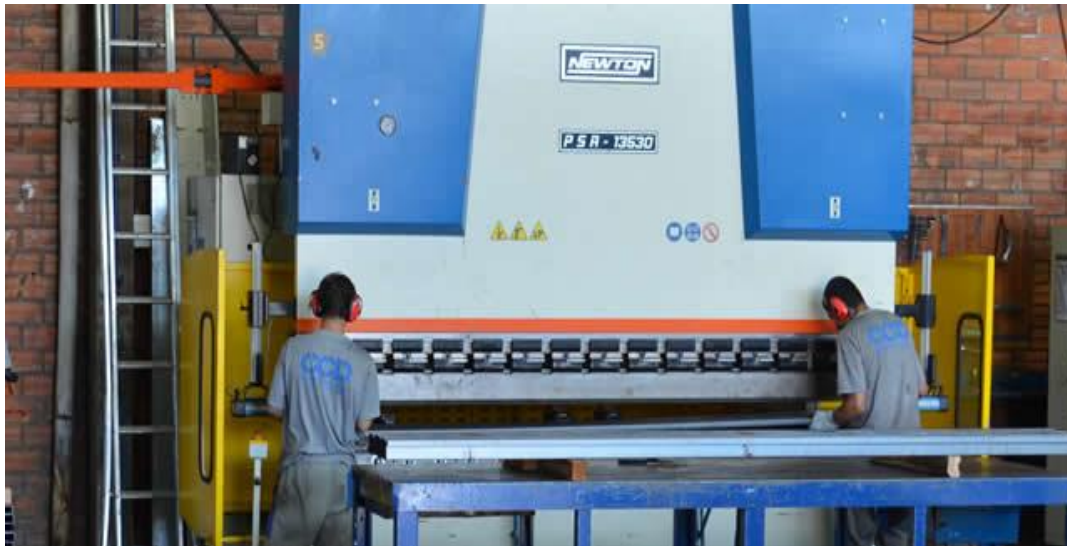
Figura 1.2 – Fabricação de perfis formados a frio empregando dobradeira (CCDCANOAS)
