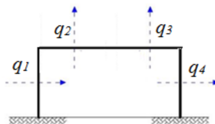
Figura 58 – Atuação do vento de treliça reta com vento a 90^\circ (Gonçalves et al. , 2013)
