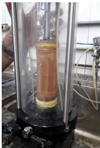
Figura 5.4 - Corpo de prova no interior da câmara triaxial, envolto por papel filtro e uma membrana de látex
