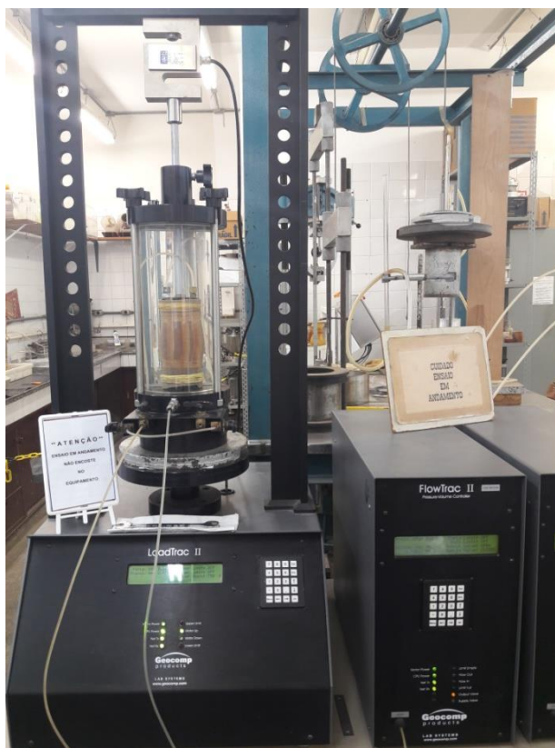
Figura 5.5 - Equipamentos utilizados na realização dos ensaios triaxiais
