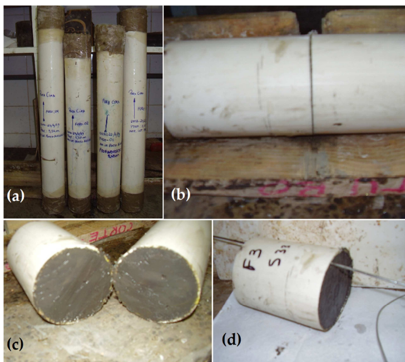
Figura 3.8 – Ensaio de adensamento: (a) Amostras em tubo de PVC; (b) Corte transversal no tubo; (c) Vista frontal da amostra; (d) Transpasse do fio de aço entre o tubo e a amostra.
