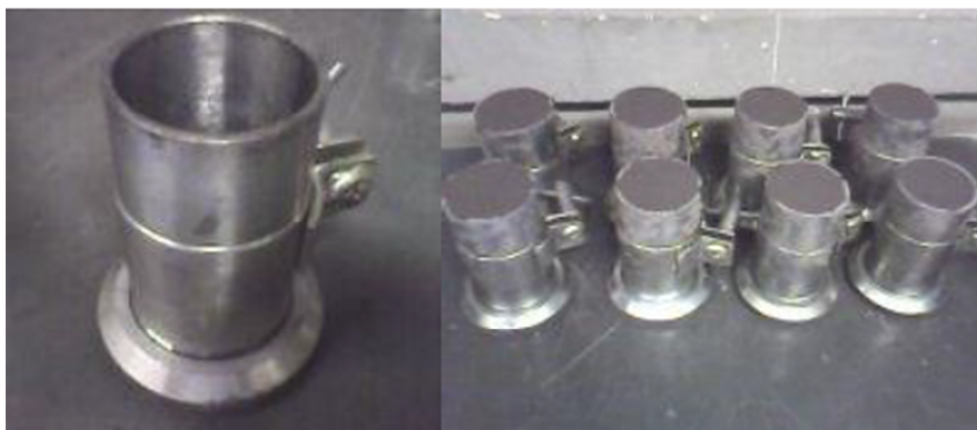
Figura 3.3 – Forma e corpos de prova moldados.
