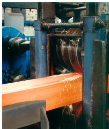
Figura 1.1. Produção de uma seção poligonal de quatro lados (WARDENIER et al. ,2010).
