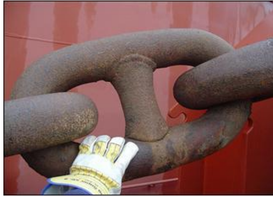
Figura 2.2- Amarra utilizada para ancoragem de sistema offshore [5]
