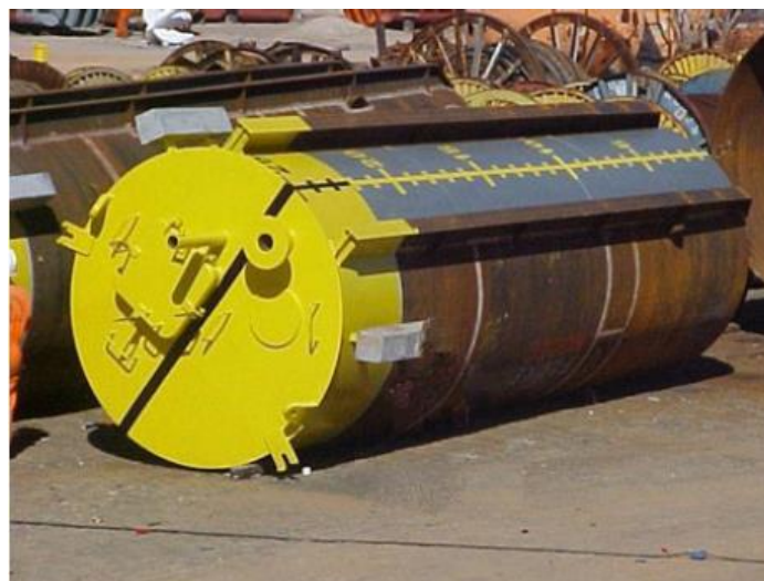
Figura 2.12- Estaca de Sucção [4]
