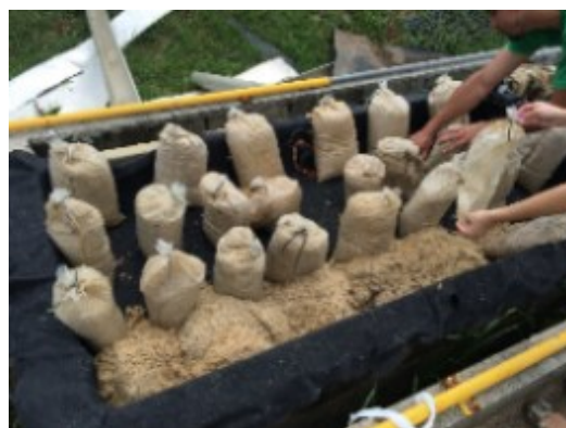
Figura 4.17 – Processo de lançamento da areia dos sacos para o protótipo.
