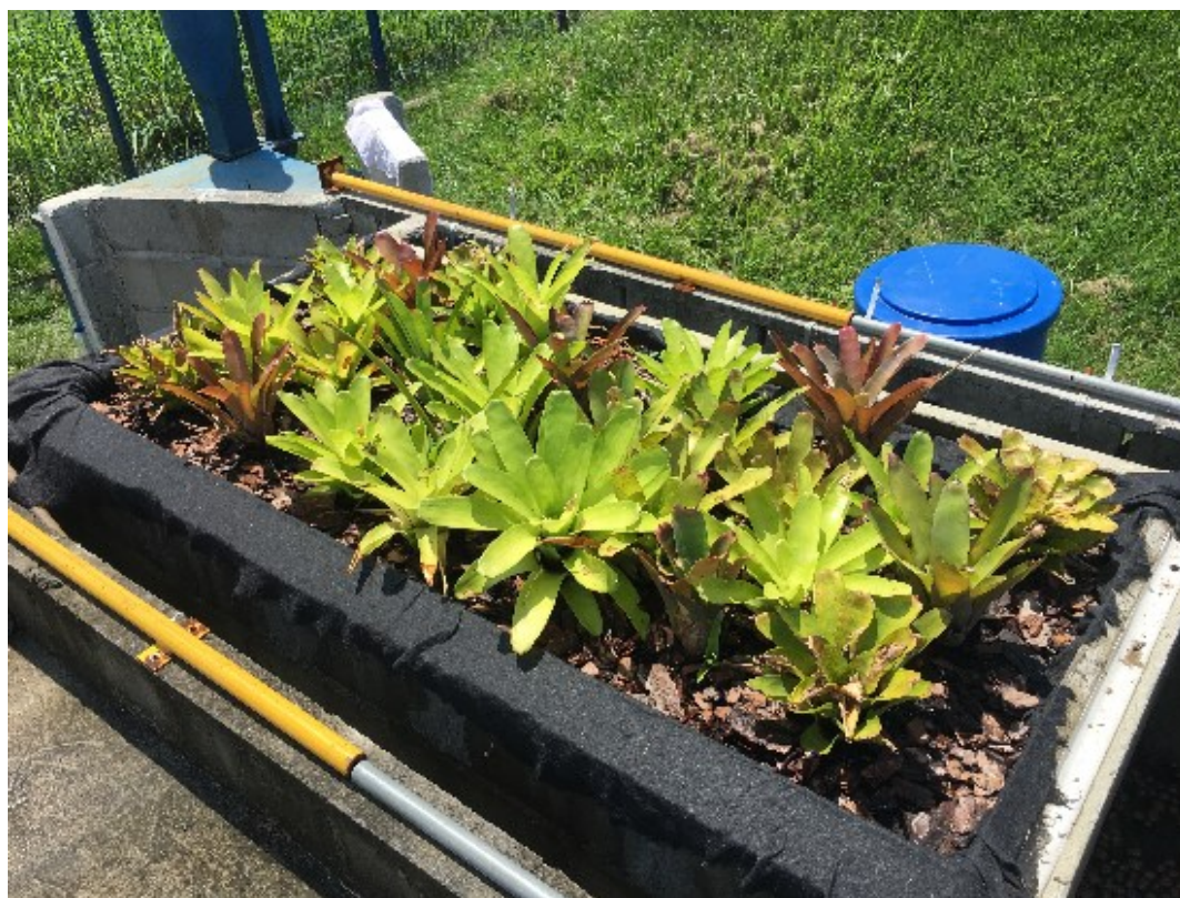
Figura 4.32 – Protótipo de telhado verde utilizado nos ensaios experimentais.
