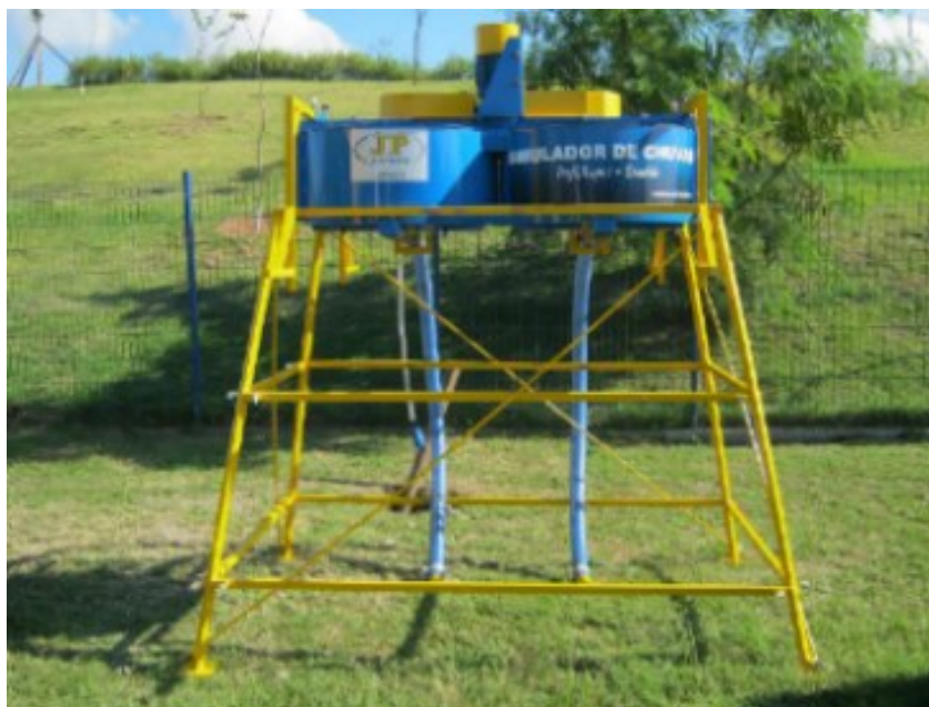
Figura I.1 – Simulador de Chuvas InfiAsper – Double .
