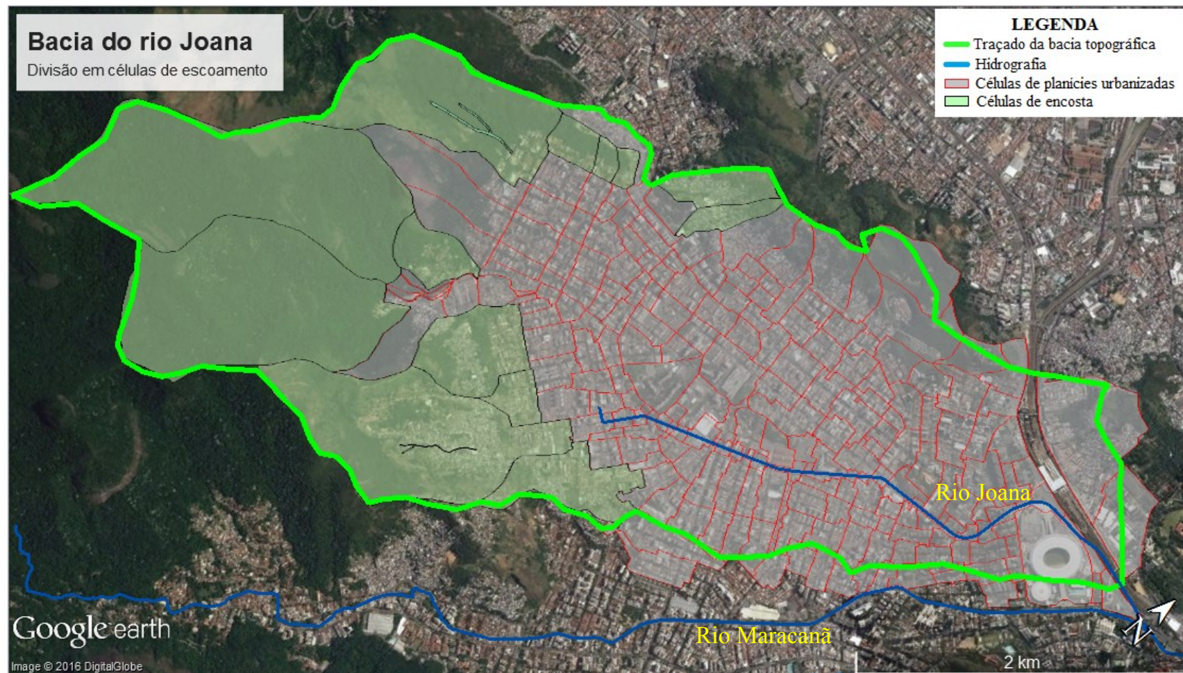
Figura 6.1 – Bacia do rio Joana dividida em células de escoamento para a modelagem.
