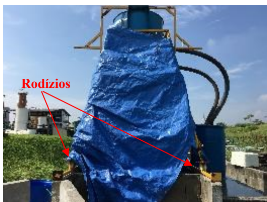
Figura I.2 – Rodízios implantados no Simulador de Chuvas (vista 1).
