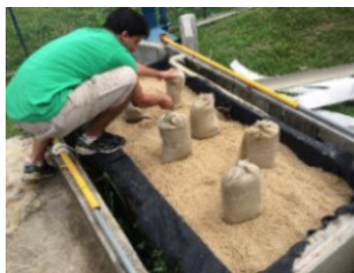
Figura 4.19 – Procedimento para aumentar a espessura da subcamada.
