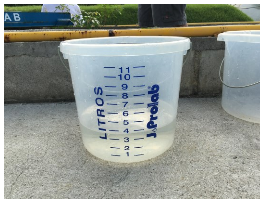
Figura 4.38 – Balde graduado utilizado para verificar o volume precipitado.
