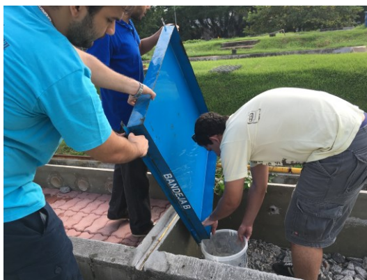
Figura 4.37 – Transferência da água da bandeja para o balde graduado.
