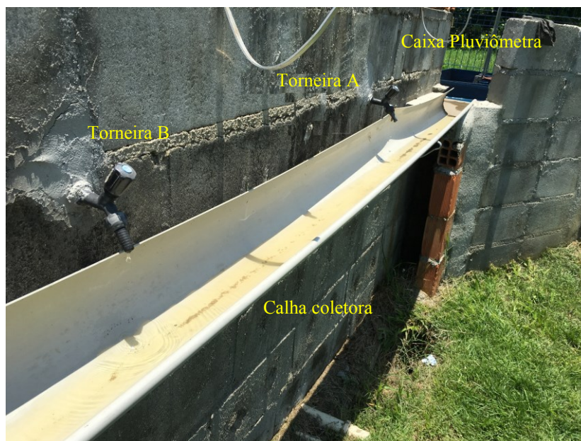
Figura 4.56 – Saídas da camada de drenagem do módulo experimental.
