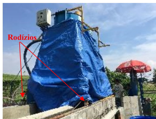
Figura I.3 – Rodízios implantados no Simulador de Chuvas (vista 2).
