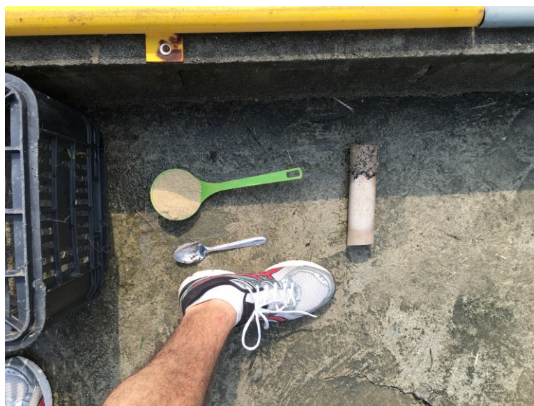
Figura 4.39 – Colheres e tubo de PVC utilizados para a coleta das amostras.
