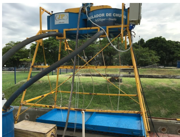
Figura 4.36 – Chuva com duração de 6 minutos sobre as bandejas de calibração.
