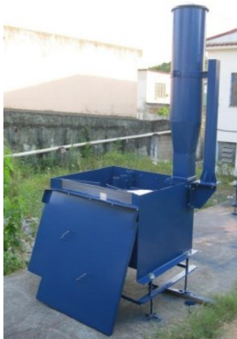
Figura II.1 – Caixa Pluviômetro pós-etapa de fabricação.
