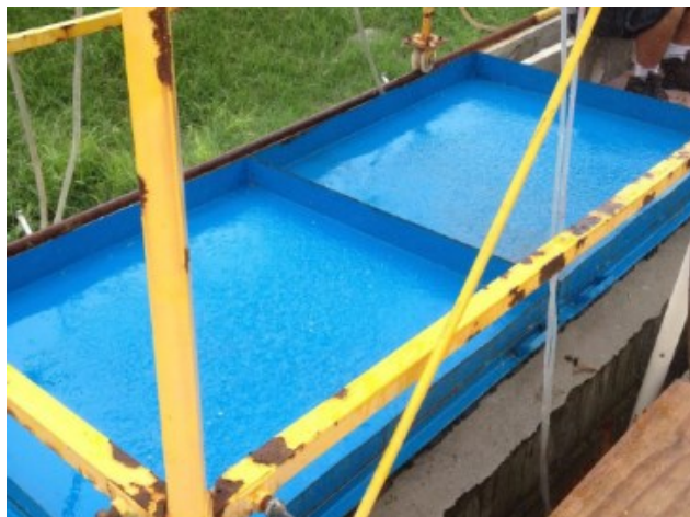
Figura 4.35 – Bandejas de calibração para determinação da intensidade da chuva produzida pelo simulador.
