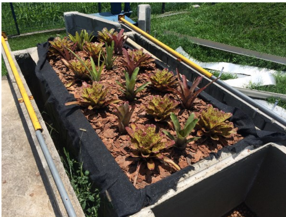
Figura 4.26 – Protótipo de telhado verde concluído em 06/11/2015.
