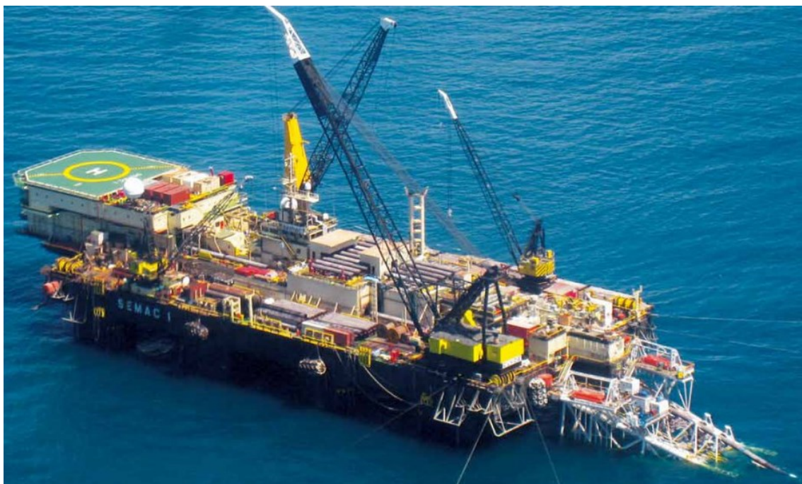
Figura 2.5 - Balsa de lançamento S-Lay [6]
