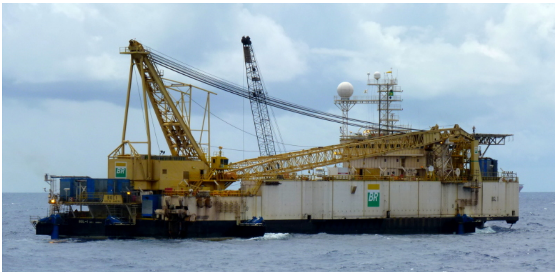
Figura 4.51 - Balsa de lançamento de dutos BGL-1 [32]
