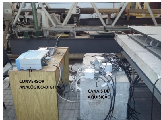
Figura 3.7: Equipamento usado para a aquisição e processamento de sinais durante os testes.
