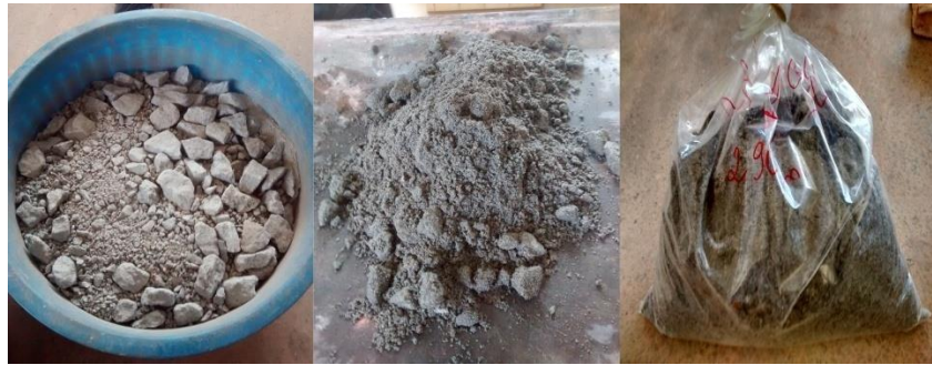
Figura 15 - Preparação da amostra (separação da granulometria, colocação da umidade ótima e guarda em saco plástico para câmara úmida)
