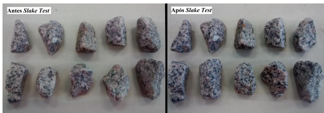
Figura 25 - Resultado do segundo ciclo do slake test para brita da amostra 1 deste estudo, fotos antes e depois
