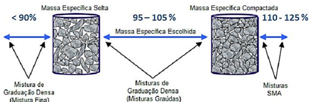
Figura 10 – Valores percentuais para determinação da massa específica de acordo com a mistura projetada (Adaptado de FERNANDES JUNIOR et al. , 2004, e VAVRIK et al. , 2002)
