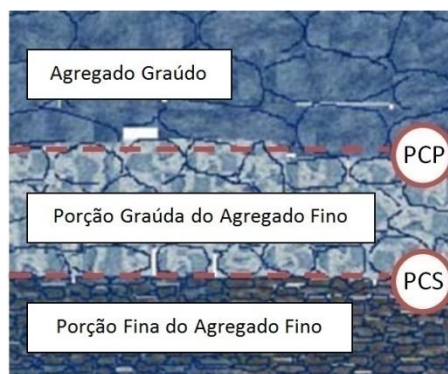
Figura 9 - Esquema das divisões e porções de agregados pelo método Bailey (Adaptado de VAVRIK et al. , 2002)
