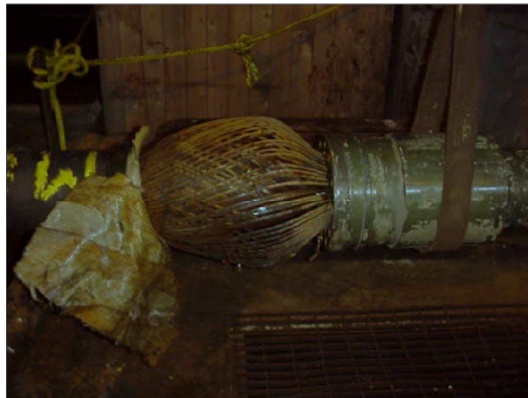
Figura 2.16 - Aspecto dos arames da armadura de tração de uma linha flexível com falha “gaiola de passarinho” [10].
