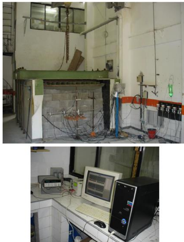
Figura 33 - Modelo físico montado e sistema de aquisição de dados utilizado para monitoração dos experimentos MF-01 e MF-02
