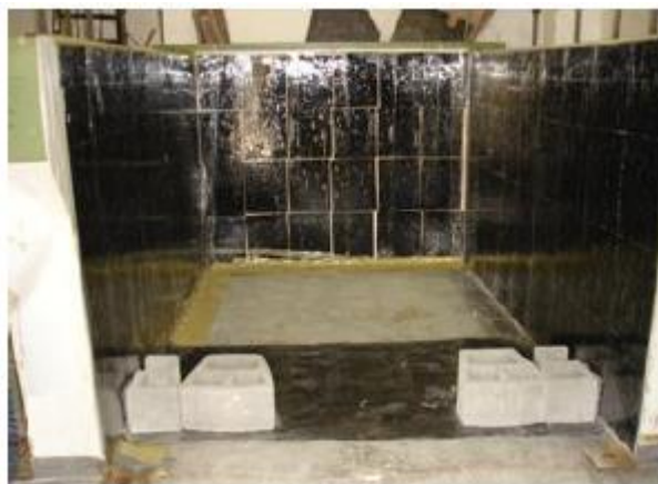
Figura 23 - Base do faceamento do modelo MF-02 sobre sistema de lubrificação (SILVA, 2010)
