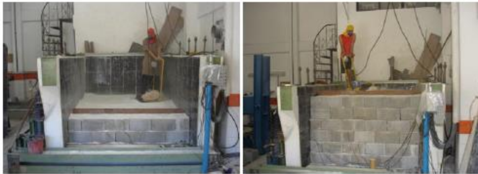
Figura 25 - Compactação realizada com placa vibratória (SILVA, 2010)
