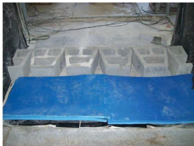
Figura 34 - Material deformável instalado na base do modelo físico (ELEUTÉRIO, 2013)
