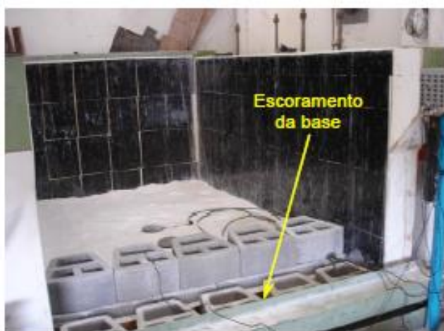
Figura 24 - Sistema de escoramento das bases dos modelos físicos (SILVA, 2010)
