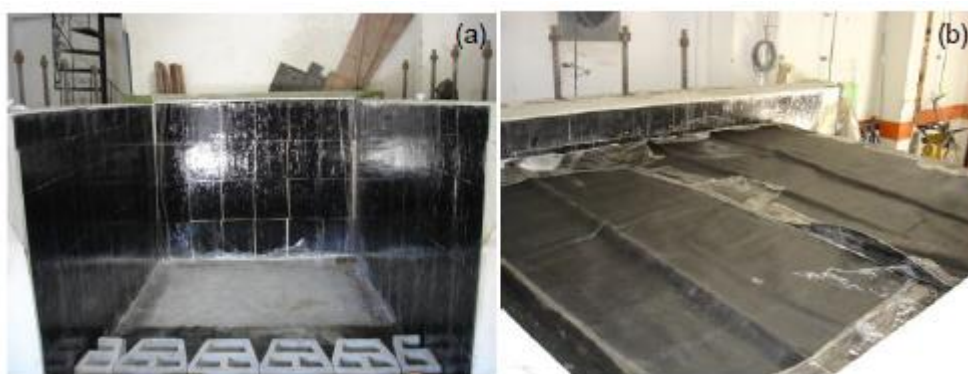
Figura 22 – Sistema de lubrificação das superfícies de contato com o solo para evitar influência do atrito nas interfaces dos materiais: (a) parede da caixa de ensaio e (b) superfície do terrapleno que receberá a bolsa de ar comprimido responsável pela aplicação da sobrecarga. (SILVA, 2010).
