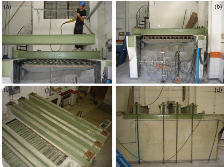
Figura 30 - Sistema de aplicação da sobrecarga composto por bolsa de ar comprimido e estrutura de reação; (a) montagem da estrutura de reação e vistas; (b) frontal; (c) superior e (d) lateral.
