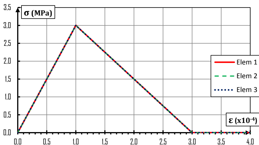
Figura 4.49 - Curva Tensão x Deformação para Fissura Distribuída em todo Corpo
