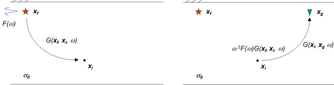
Figura 2.5: Interpretação física da equação 2.12, as componentes da matriz Jacobiana atuam como propagador da energia no meio.
