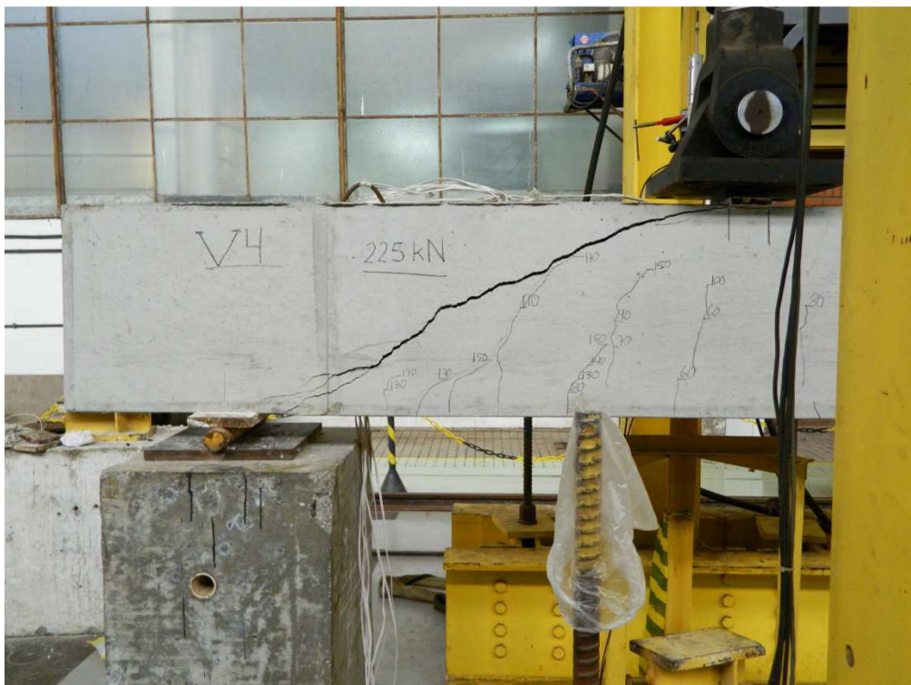
Figura 3.21 – Aspecto pós-ruptura da viga V4 ( F_u=225\text{kN} ).
