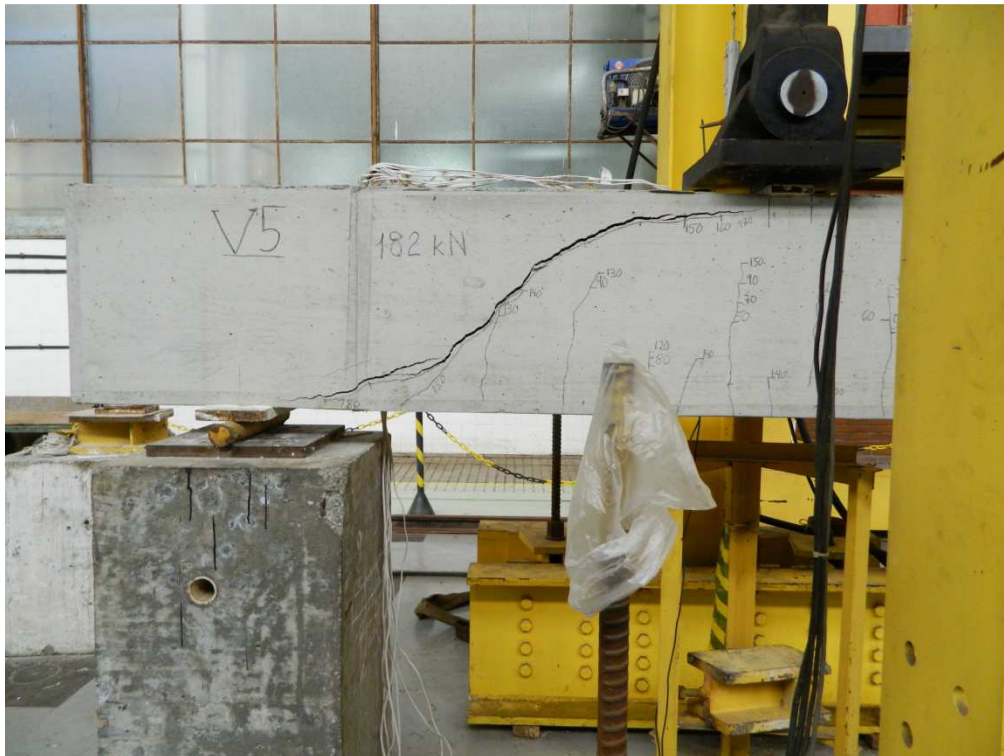
Figura 3.20 – Aspecto pós-ruptura da viga V5 ( F_u=182\text{kN} ).
