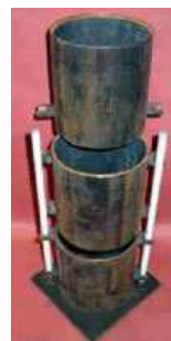
Ensaio de segregação da coluna
