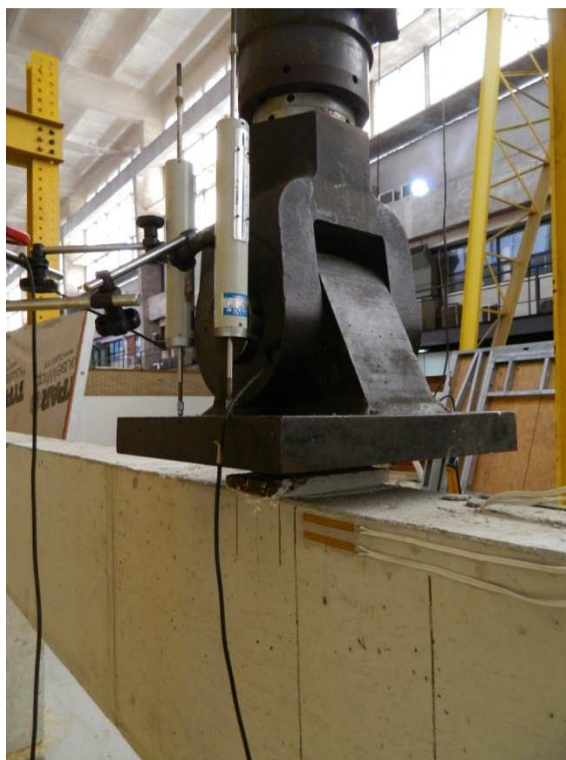
Figura 3.12 – Posições dos transdutores de deslocamento na placa de aço do atuador hidráulico e dos extensômetros elétricos de resistência no concreto.
