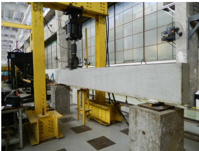
Figura 3.13 – Viga pronta para ser ensaiada.
