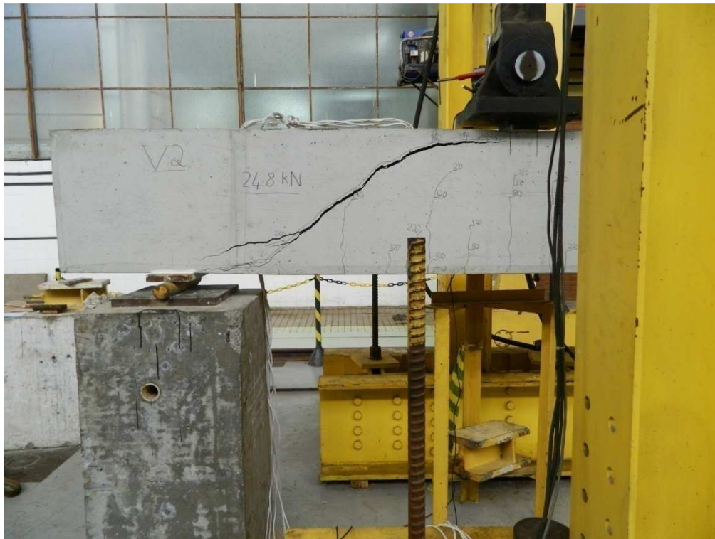
Figura 3.18 – Aspecto pós-ruptura da viga V2 ( F_u=248\text{kN} ).
