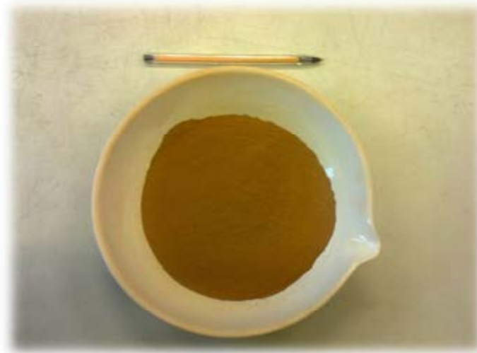
Figura 3.15: Cinza de lodo de ETE obtida a temperatura de 550°C e destorroada com almofariz e mão de gral, usada no presente estudo
