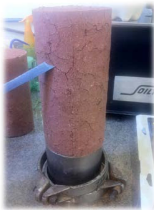
Figura 4.22: Trincas ocorridas durante a cura devido a expansão da mistura S82L15C3 deste estudo
