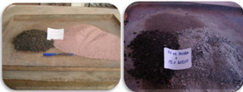
Figura 3.18: Misturas S85L15 e P85L5 para um corpo de prova
