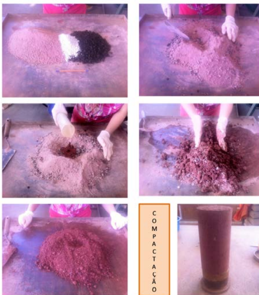
Figura 3.19: Procedimento para mistura de solo-resíduo-estabilizante
