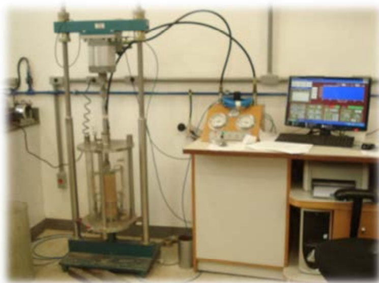
Figura 3.26: Equipamento de ensaio triaxial de cargas repetidas do Laboratório de Geotecnia e Pavimentos da COPPE/UFRJ
