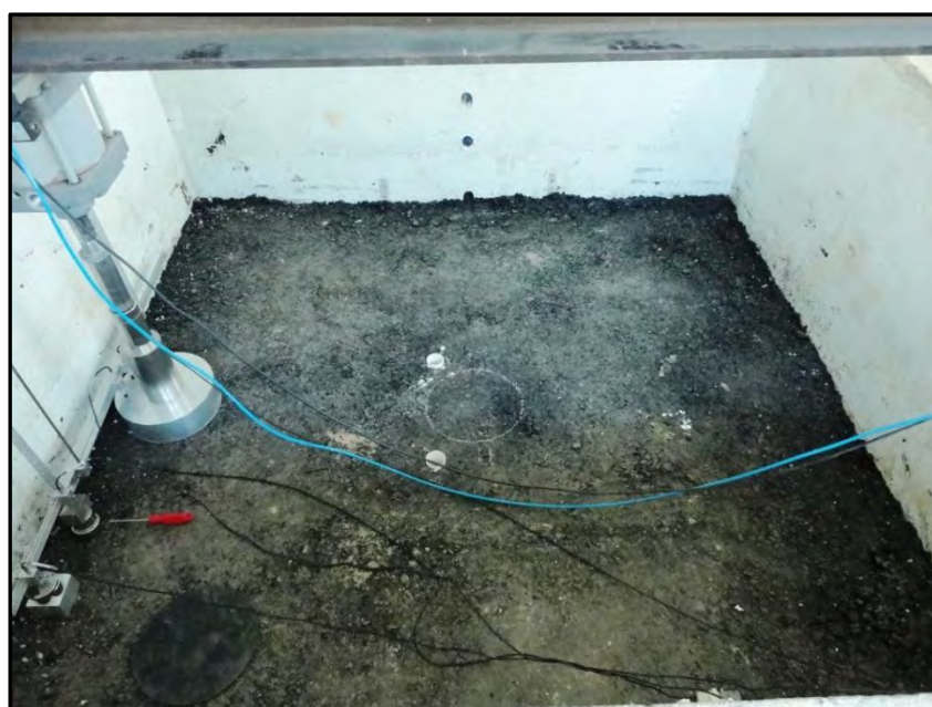
Figura 4.18: Reposicionamento do sistema de carregamento no tanque-teste para verificar o efeito das paredes na distribuição de tensões
