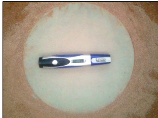
Nivelamento da célula de pressão
