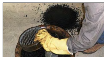
Peneiramento do material para cobrir o SG
