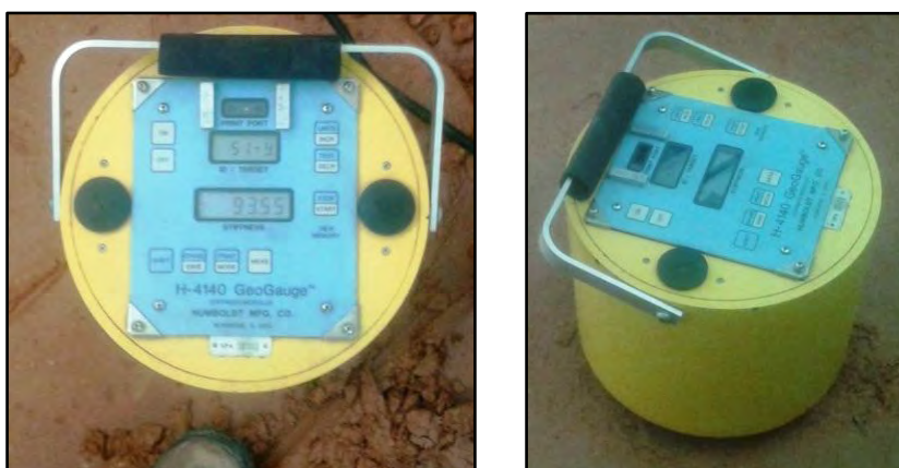
Figura 3.30: Geogauge H-4140 usado neste estudo
