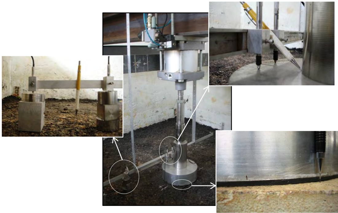
Figura 3.35: Detalhes da placa de carregamento e da borracha
