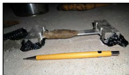
Colocação do SG no topo da base
