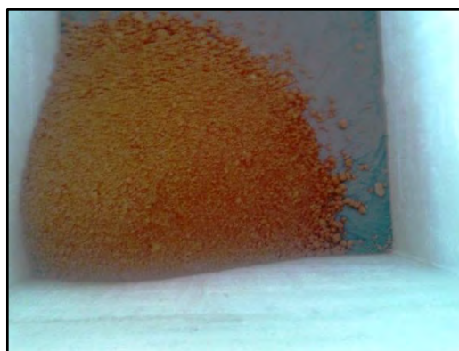
Espalhamento do solo no tanque
