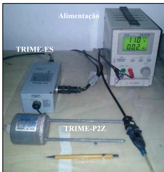
Figura 3.20: Conjunto para monitoração de umidade usado nesta dissertação
