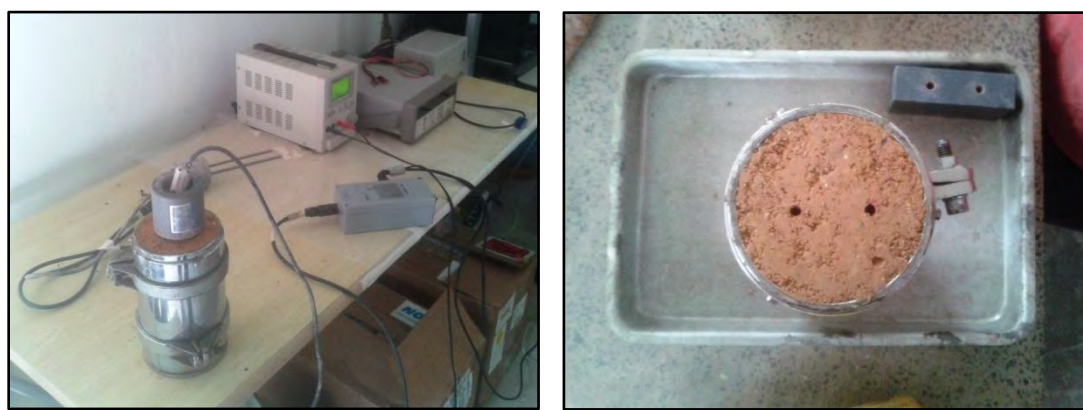
Figura 3.21: Calibração dos TDRs instalados no subleito do Tanque-Teste
