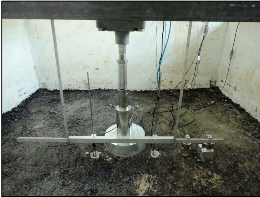
Figura 4.16: Montagem dos LVDTs para medida de deflexão na Base nesta pesquisa
