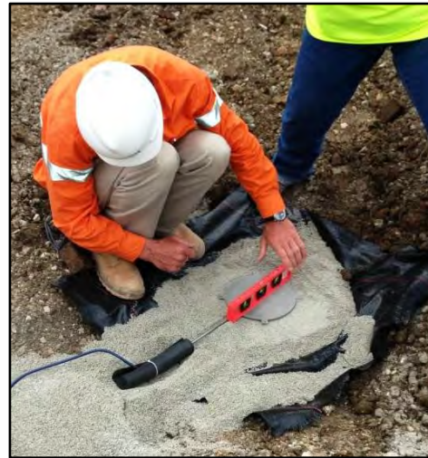
Figura 2.13: Instalação de células de pressão total (adaptado de Dunicliff, 1998; GETEC, 2014)
