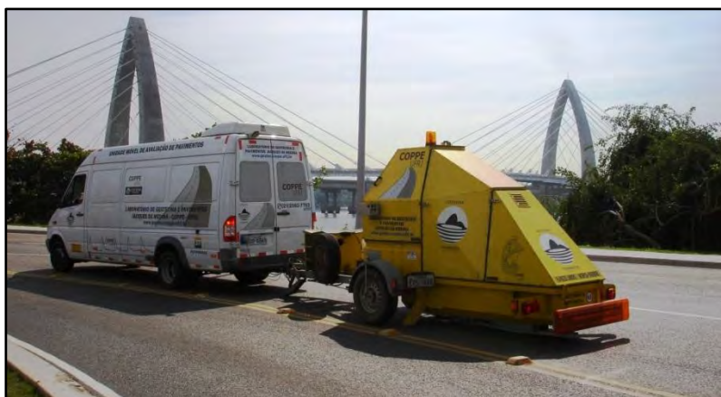
Figura 3.42: Levantamento defletométrico na estrutura real correspondente ao pavimento construído no Tanque-Teste neste estudo
