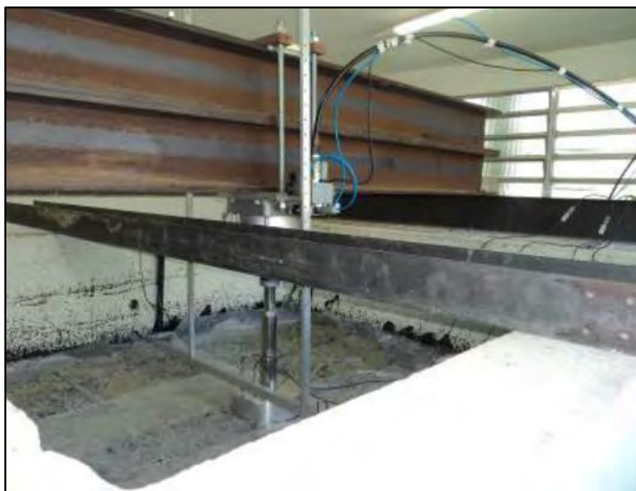
Figura 2.17: Sistema de aplicação de carga no “Tanque-Teste” (MIRANDA, 2013)
