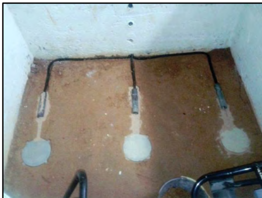
Células de pressão a 30 cm do fundo do subleito
