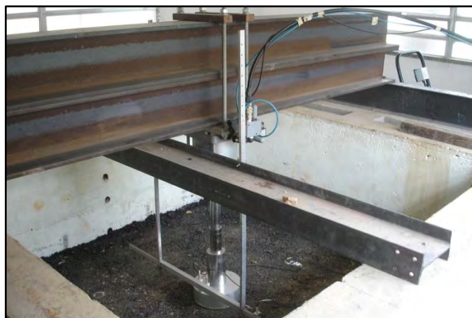
Figura 3.34: Sistema de carregamento do modelo físico neste experimento
