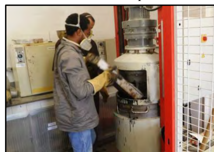
Colocação do agregado no misturador
