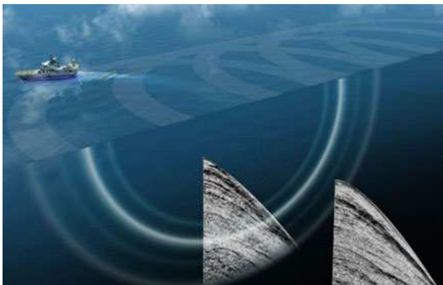
Figura 2.2.4 - Aquisição sísmica em círculos ( Coil Shooting Acquisition ) proposta pela Schlumberger (Imagem retirada do site www.slb.com ).
