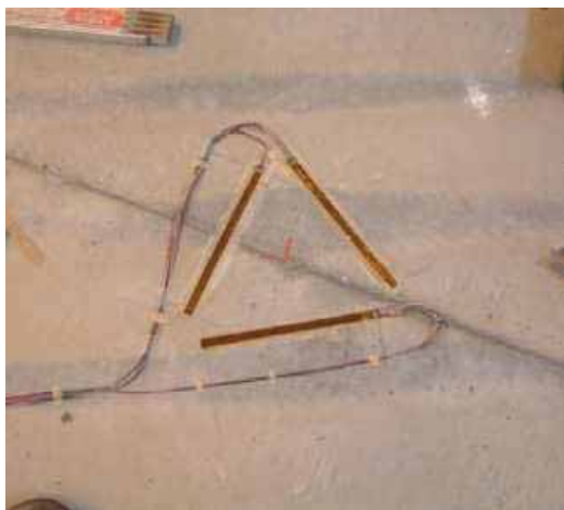
(a) Sistema triangular composto por três strain gages .
