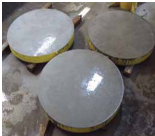
(b) Moldes preenchidos com concreto autoadensável reforçado com fibras de aço.
