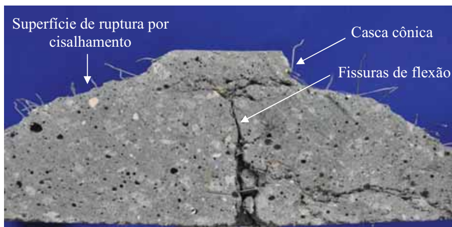
Figura 5.59 – Seção transversal do cone de punção.
