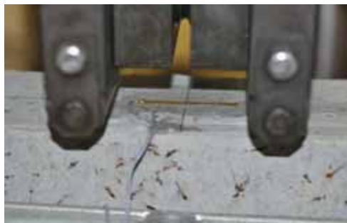
(c) Colagem dos strain gages nos prismas.
