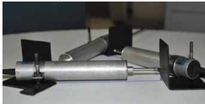
(c) Vista lateral do sistema de LVDT's.
