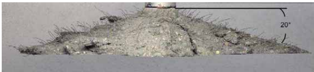
Figura 5.58 – Cone de punção extraído de um painel circular de concreto (C1,5%) submetido à Configuração III.
