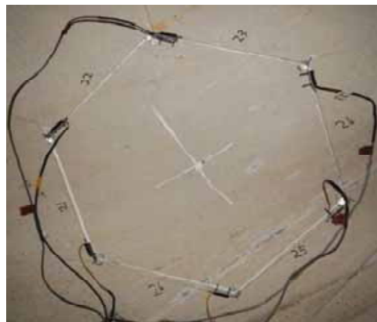
(b) Sistema hexagonal composto por seis LVDT's.
