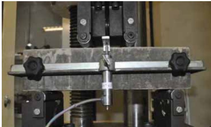
Figura 4.10 – Detalhes do arranjo experimental utilizado para os ensaios de resistência à flexão.
