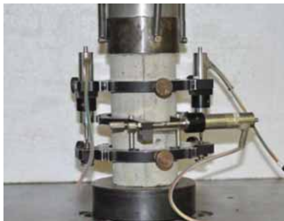
Figura 4.6 – Configuração do ensaio de resistência à compressão uniaxial.
