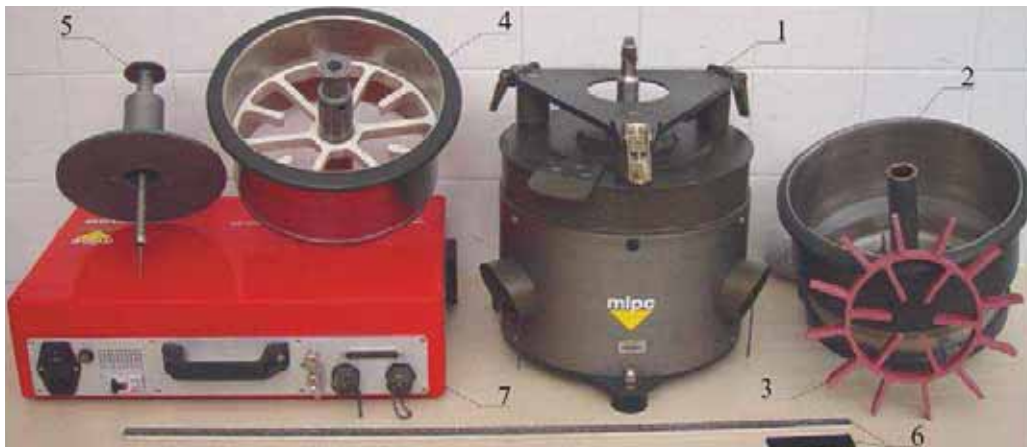
Figura 4.2 – Constituintes do reômetro BTRHEOM: base que contém motores e transdutores (1), recipiente que comporta a amostra de concreto (2), grade fixa inferior (3), unidade de rotação com grade superior (4), dispositivo para medição da dilatância (5), fitas adesivas (6) e unidade eletrônica de controle (7).
