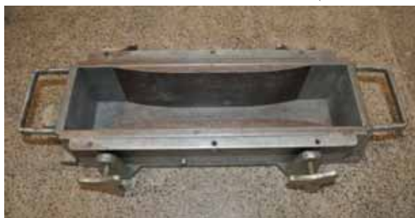
(b) Molde com redutores de seção.
