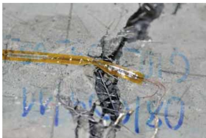
Figura 5.35 – Rompimento do strain gage inferior.
