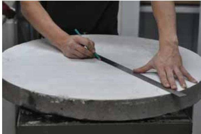
(a) Marcação dos pontos de apoio e do ponto de aplicação de carga nos painéis de concreto.
