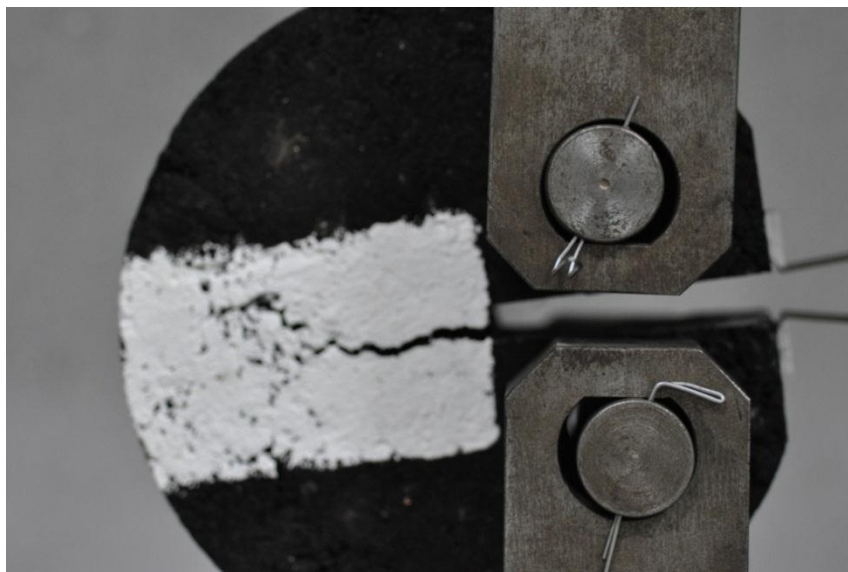
Figura 4.1 – Processo de evolução da trinca no corpo-de-prova 15744 CAP 30/45 submetido ao ensaio de fratura.
