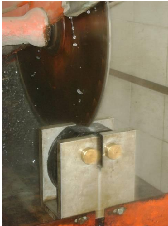
Figura 3.23 - Corpo-de-prova sendo serrado (trinca inicial), com injeção de água no Laboratório de Geotecnia da COPPE/UFRJ. Foto- Acervo da autora deste trabalho.
