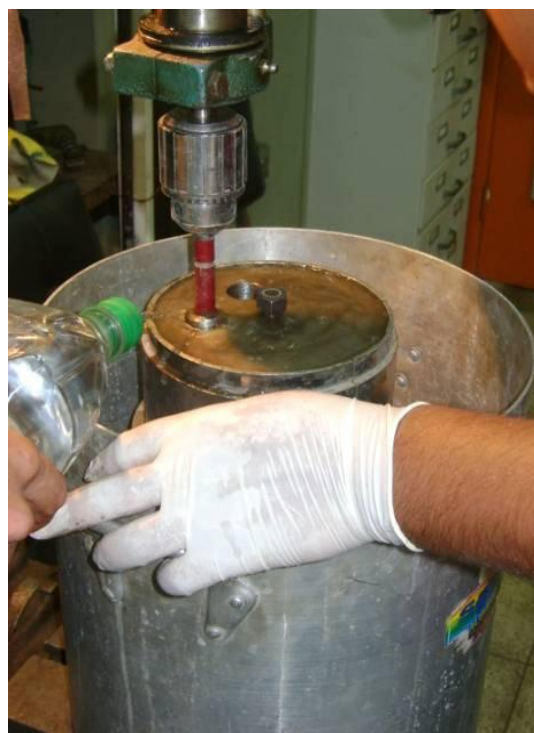
Figura 3.22 - Injeção de água durante a realização dos furos na COPPE/UFRJ. Foto - Acervo da autora deste trabalho.
