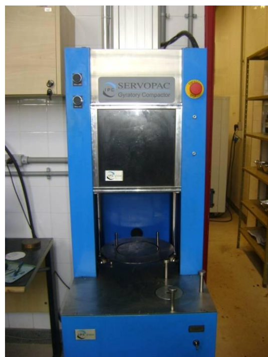
Figura 3.5 - Compactador giratório IPC Servopac com sistema de carga eletro-pneumático utilizado nesta pesquisa. Foto da autora deste trabalho de equipamento da COPPE/UFRJ.
