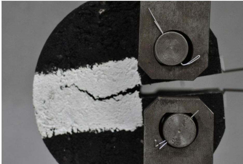
Figura 4.4 - Processo de evolução da trinca no corpo-de-prova 15747 Ecoflex submetido ao ensaio de fratura.
