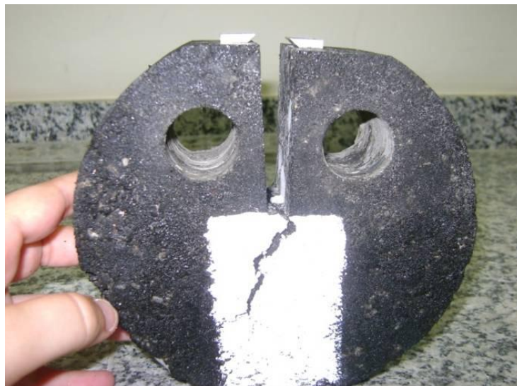
Figura 3.35 - Detalhe da propagação da trinca em uma das amostras desta pesquisa após o ensaio de Fratura. Foto - Acervo da autora deste trabalho.
