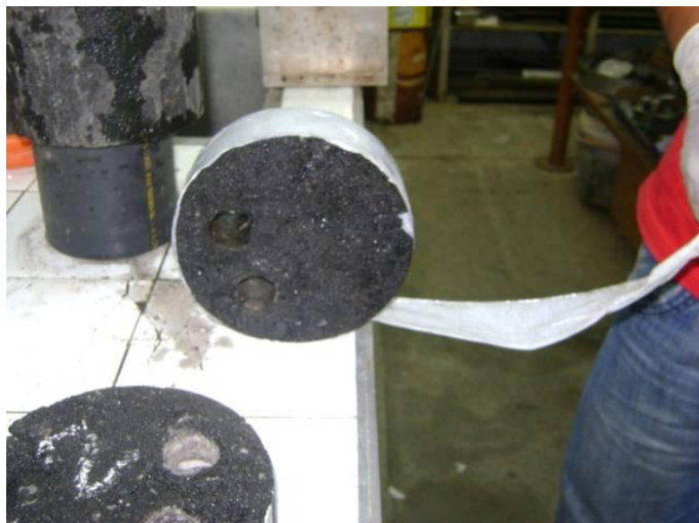
Figura 3.19 - Corpo-de-prova sendo envolvido com fita adesiva no Laboratório de Geotecnia da COPPE/UFRJ. Foto - Acervo da autora deste trabalho.
