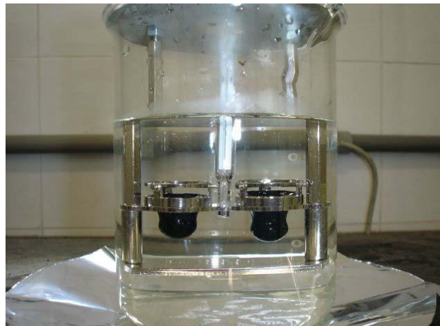
Figura 2.4 - Ensaio do ponto de amolecimento em execução (Fonte: Cavalcanti, 2010).
