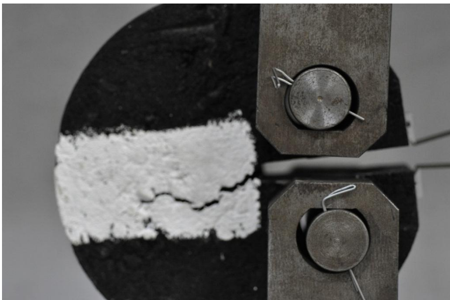
Figura 4.3 - Processo de evolução da trinca no corpo-de-prova 15746 CAP 30/5 submetido ao ensaio de fratura.
