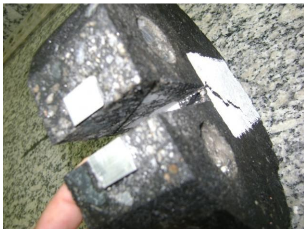
Figura 3.25 - Detalhe das placas coladas na amostra para o ensaio de fratura.
