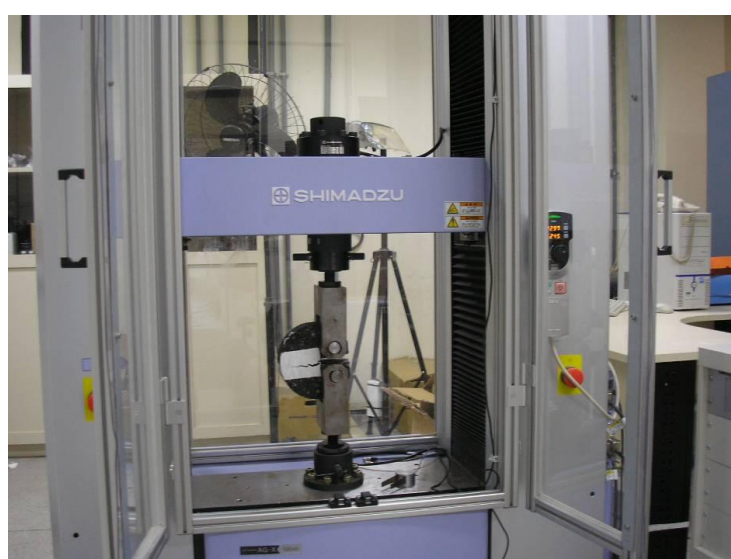
Figura 3.33 - Equipamento utilizado na realização dos ensaios de fratura no Laboratório de Estruturas da COPPE/UFRJ. Fonte - Acervo da autora deste trabalho.
