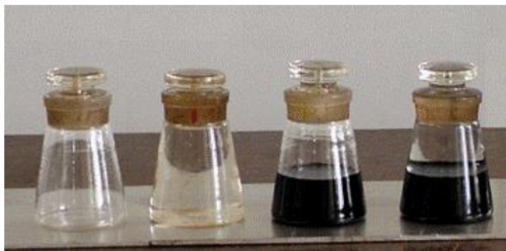
Figura 2.6 - Sequência de etapas do ensaio de massa específica de ligante usando picnômetro (Foto: Cavalcanti, 2010).
