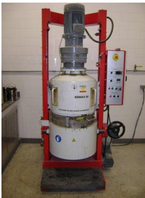
Figura 3.4 - Misturador mecânico francês modelo BBMAX80 com capacidade máxima para 80 kg de mistura usado neste estudo. Foto da autora deste trabalho de equipamento da COPPE/UFRJ.
