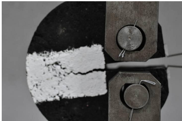
Figura 3.34 - Configuração de carregamento durante o ensaio – detalhe das garras e do clip-on-gage no equipamento utilizado nesta pesquisa na COPPE/UFRJ. Foto - Acervo da autora deste trabalho.
