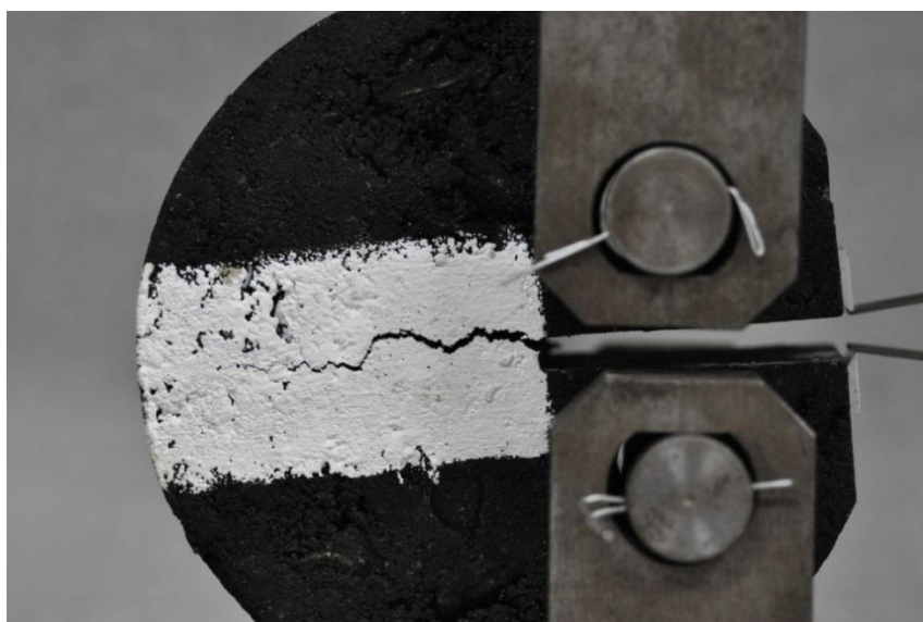
Figura 4.2 - Processo de evolução da trinca no corpo-de-prova 15745 CAP 30/45 submetido ao ensaio de fratura.
