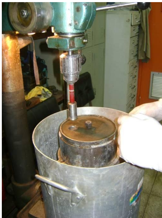
Figura 3.21 - Corpo-de-prova e gabarito dentro do molde para realização dos furos de carregamento, no Laboratório de Geotecnia da COPPE/UFRJ. Foto - Acervo da autora deste trabalho.
