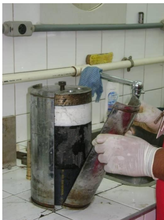
Figura 3.20 - Colocação do corpo-de-prova dentro do molde no laboratório de Geotecnia da COPPE/UFRJ. Foto - Acervo da autora deste trabalho.
