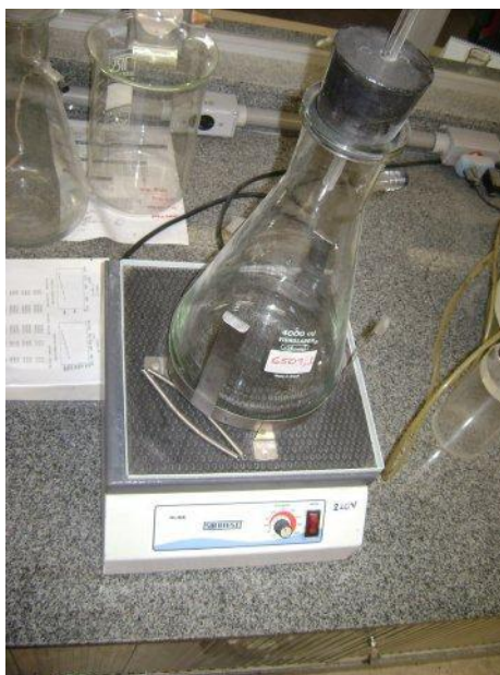
Figura 2.15 - Equipamento básico de determinação da Gmm, utilizando vácuo. (COPPE/UFRJ).
