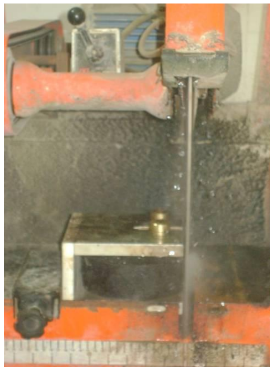
Figura 3.24 -Corpo-de-prova sendo serrado (face para acoplamento do clip ongage ), com injeção de água no Laboratório de Geotecnia da COPPE/UFRJ. Foto -Acervo da autora deste trabalho.
