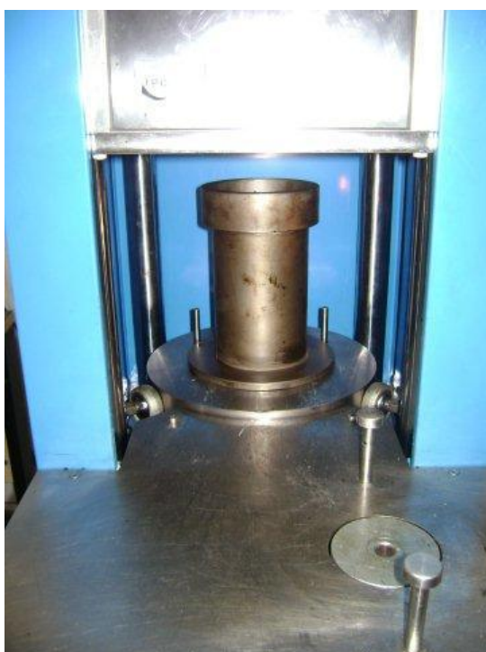
Figura 3.5 - Compactador giratório IPC Servopac com sistema de carga eletro-pneumático utilizado nesta pesquisa. Foto da autora deste trabalho de equipamento da COPPE/UFRJ.
