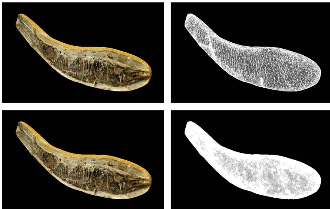
Figura 16. No alto o modelo 3D otimizado (3.200 polígonos) com a textura (à esquerda) e mostrando apenas a malha poligonal (à direita). Em baixo o modelo 3D em qualidade máxima (209.568 polígonos) com a textura (à esquerda) e mostrando apenas a malha poligonal (à direita).
