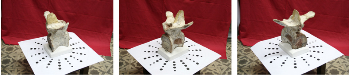
Figura 11. Fotos de uma vértebra usadas na reconstrução 3D da espécie Pynonemosaurus com fundo simplificado e melhor qualidade no calibration mat .
