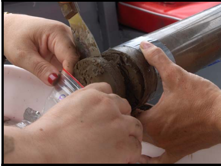
Figura 11. Corte do testemunho
