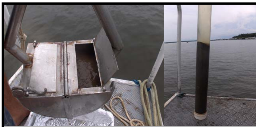
Figura 10. Coleta sedimento superficial e testemunho
