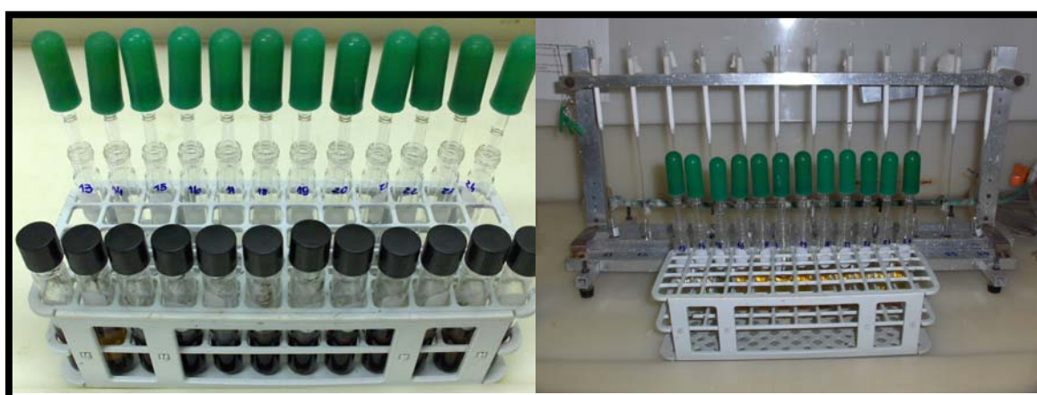
Figura 17. Solução orgânica com extratos de lignina e rack de secagem com colunas de \text{Na}_2\text{SO}_4 .
