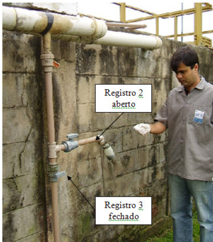
Figura 38 – Procedimento de coleta do efluente do FBP para análise de OD e temperatura
