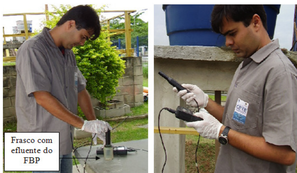
Figura 37 – Medição “in loco” de OD (mg/l) e temperatura
