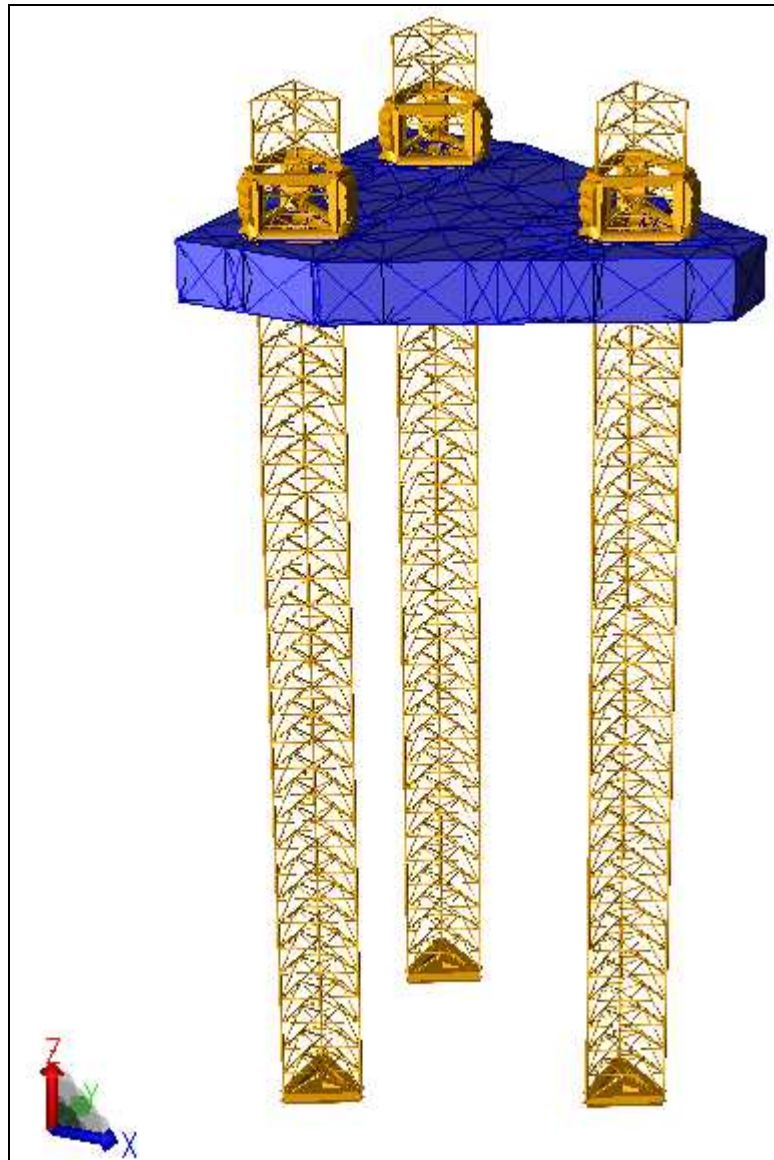
Figura V.1-2 - Modelo sólido da plataforma auto-elevatória
