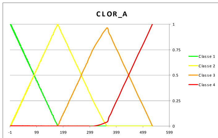
Gráfico 20: Partições fuzzy para a variável de clorofila-a para as coletas de água superficial.
