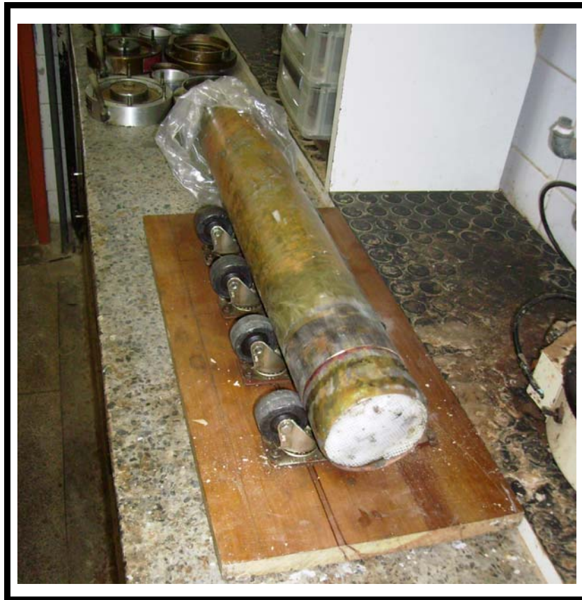
Figura F.1: Tubo amostrador apoiado sobre rodízios já sem a lacragem externa
