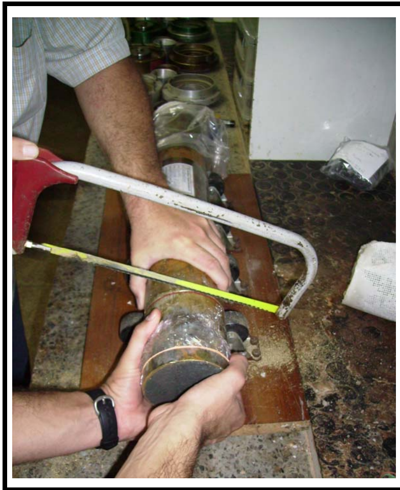
Figura F.2: Corte de um segmento do tubo amostrador para moldagem de corpos de prova para ensaio de adensamento
