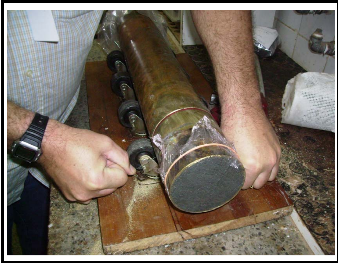
Figura F.3: Passagem do fio de aço para separação da amostra
