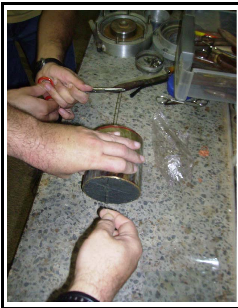
Figura F.4: Passagem do fio de aço ao longo da geratriz do segmento desconectado.
