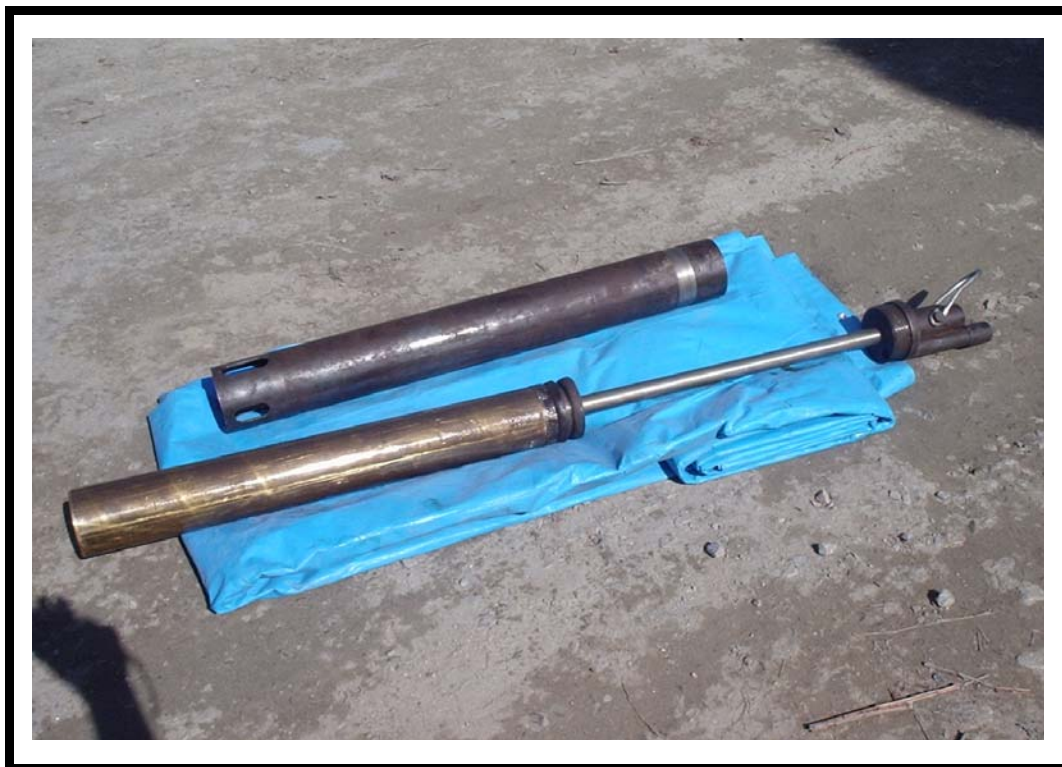
Figura D.2: Amostrador de pistão estacionário de 10cm de diâmetro interno utilizado para a extração das amostras
