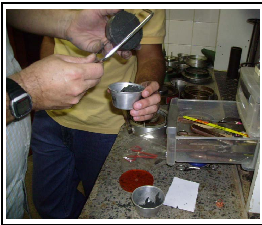
Figura F.5: Escultura do corpo de prova com o fio de corte e preenchimento das cápsulas para determinação da umidade natural
