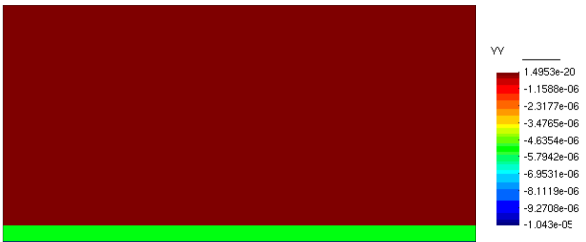
Figura 4.10 - Deformação total vertical no reservatório para uma depleção de 200 N/m 2 no reservatório.
