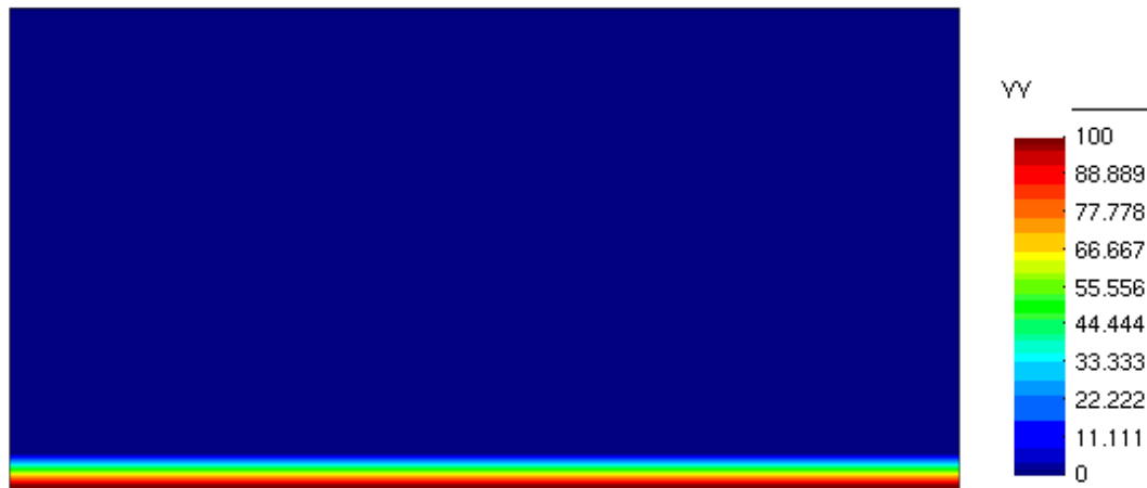
Figura 4.3 - Aplicando o diferencial de 100 N/m 2 no reservatório.
