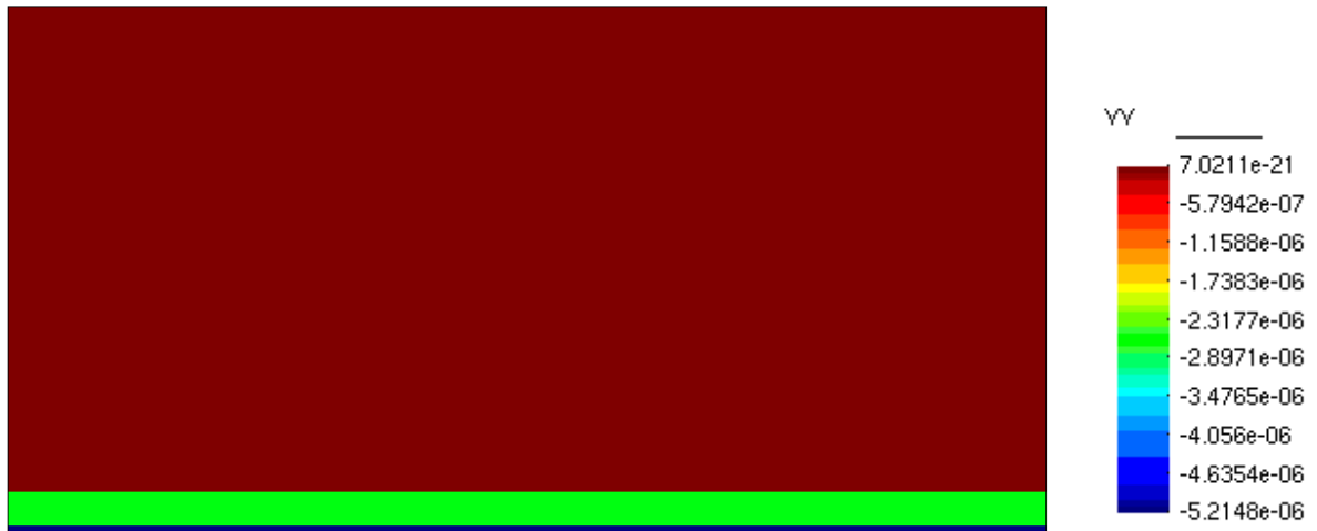
Figura 4.6 - Deformação total vertical no reservatório para uma depleção de 100 \text{ N/m}^2 no reservatório.
