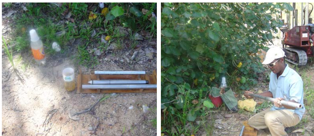
Figura 4.5 – Montagem e saturação do piezocone (área do rio João de Tiba).
