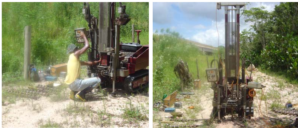
Figura 4.4 – Ensaio de piezocone (área do rio João de Tiba).
