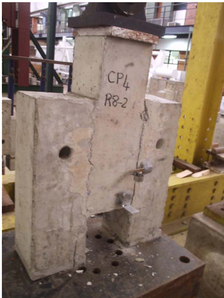
Figura 4.15 - Aspecto do exemplar E4R 8-2 após a ruptura.
