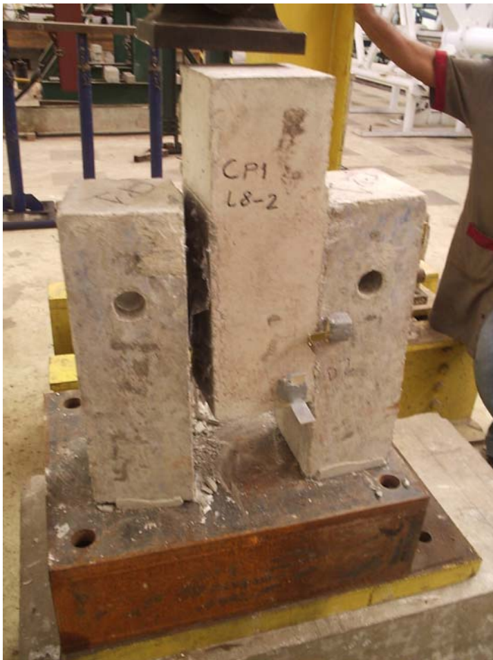
Figura 4.13 - Aspecto do exemplar E1L 8-2 após a ruptura.
