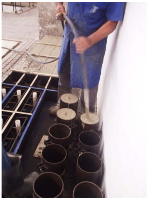
Figura 3.11 - Adensamento do concreto nos cilindros, com vibrador de imersão.
