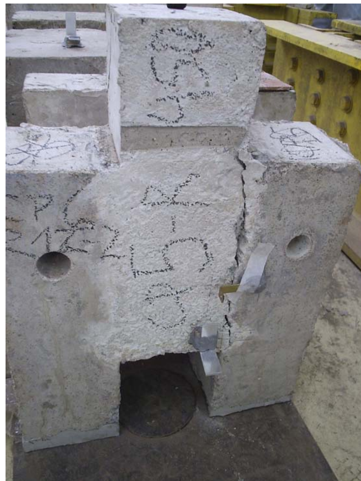
Figura 4.16 - Aspecto do exemplar E5R 10-2 após a ruptura.
