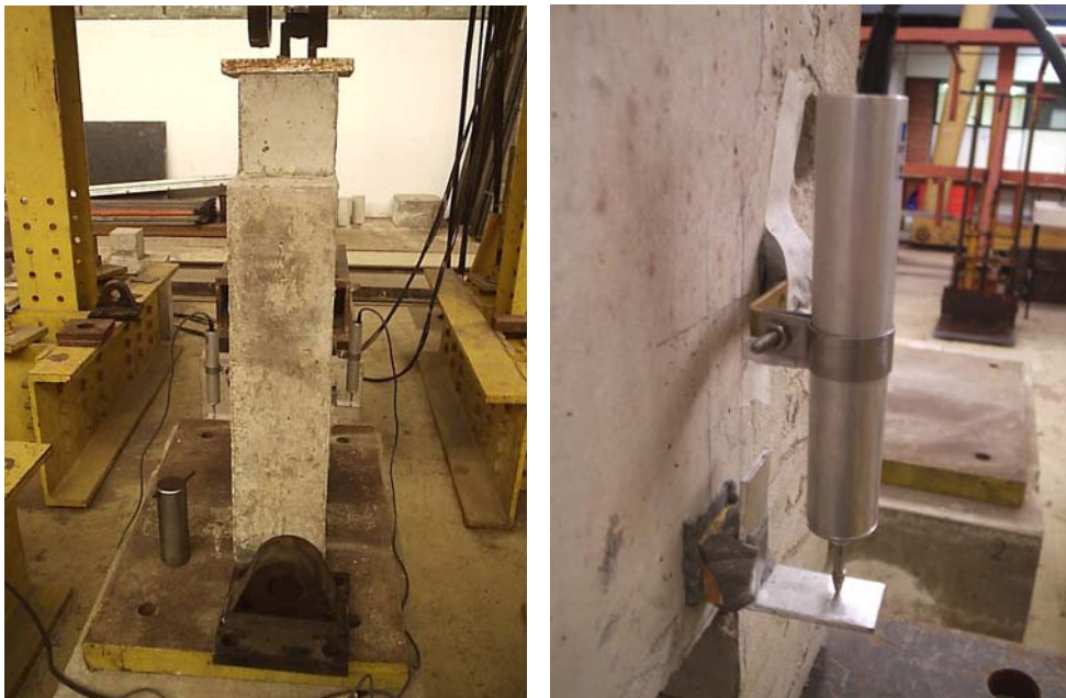
Figura 3.15 - Transdutores de deslocamento utilizados nos ensaios.
