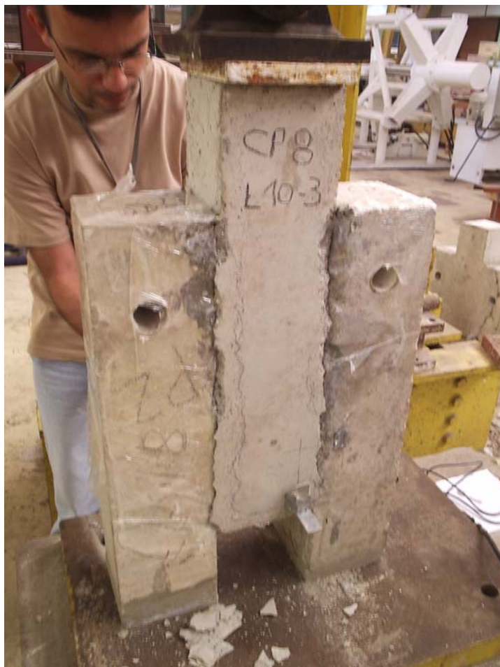
Figura 4.17 - Aspecto do exemplar E8L 10-3 após a ruptura.
